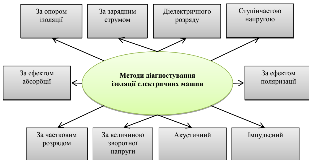
Рис. 2. Основні методи контролю ізоляції електричних машин
