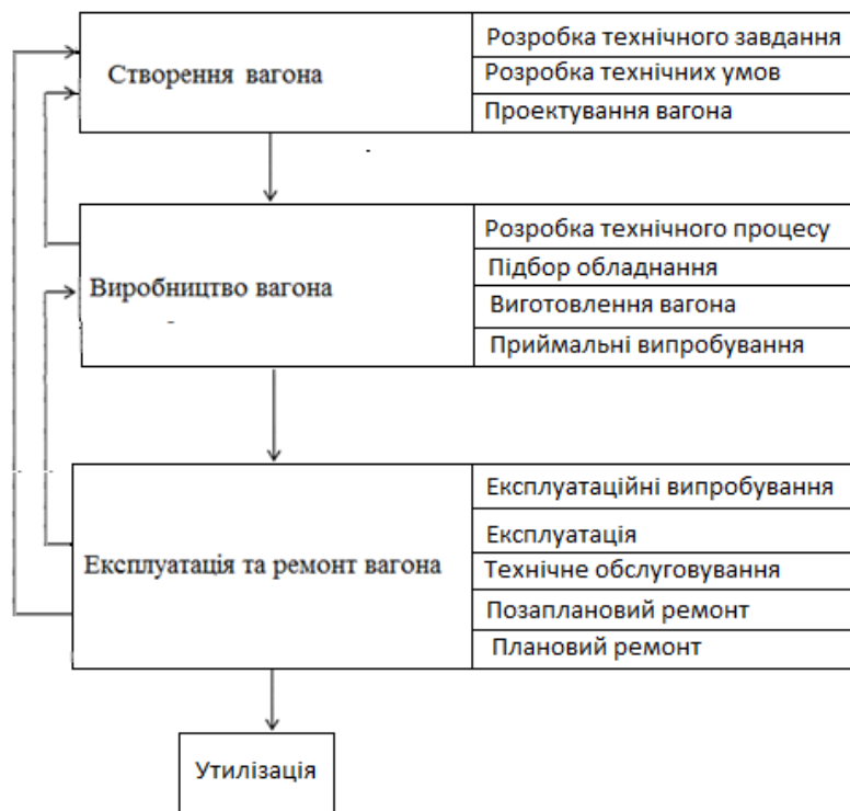
Рис. 1. Етапи життєвого циклу вантажного вагона
