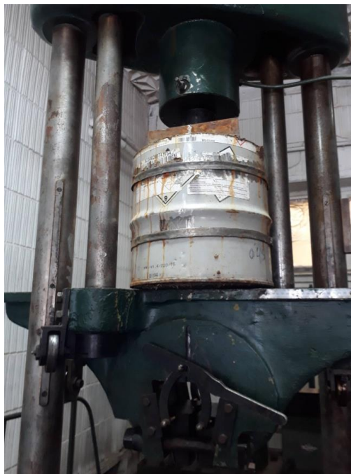
Рис. 3. Випробування моделі ґрунтополімерної композиції динамічним навантаженням
