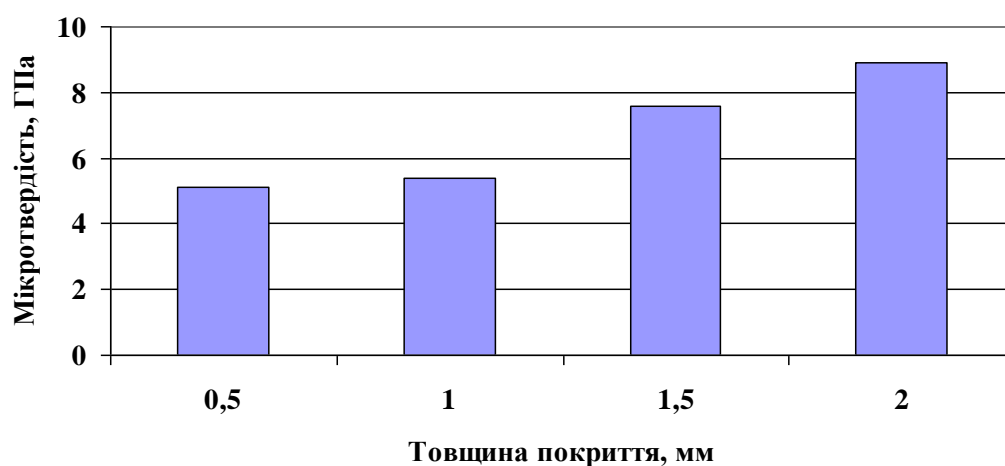
Рис. 2. Залежність мікротвердості двошарових матеріалів від товщини поверхневого шару
