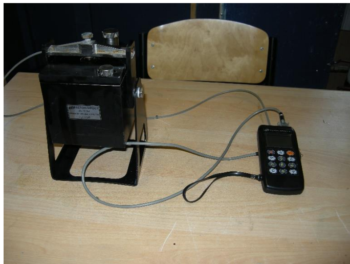
Рис. 1. Зовнішній вигляд дилатометра з електронним блоком вимірювання
