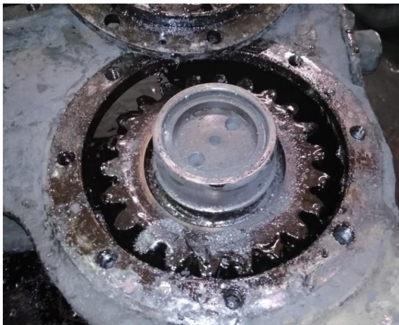
Рис. 14. Справна шестірня тягового редуктора електропоїзда після розбирання
