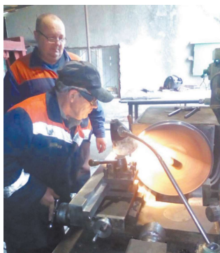
Під наглядом майстра Олександра НІКІТЕНКА токаря Володимира КОВАЛЕНКО встановлює для наплавлення чергове колесо вагоноремонтної машини
