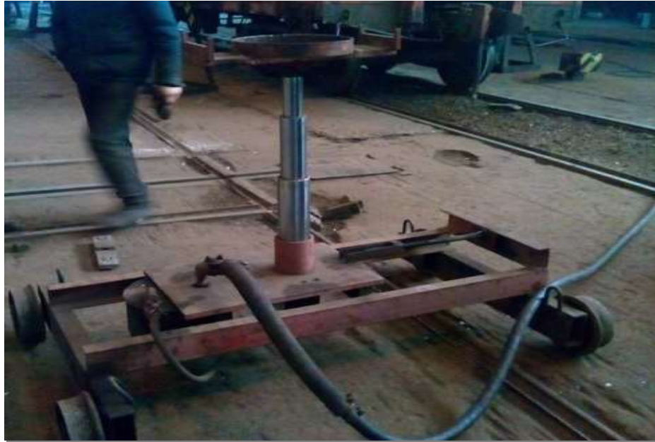
Рисунок – 1 Пристрій для демонтажу і вивозу п'ятника з-під вагону
