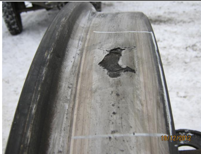
Рис. 3. Дефекти на поверхні кочення колісних пар, які виникають через несправність гальмівного обладнання
