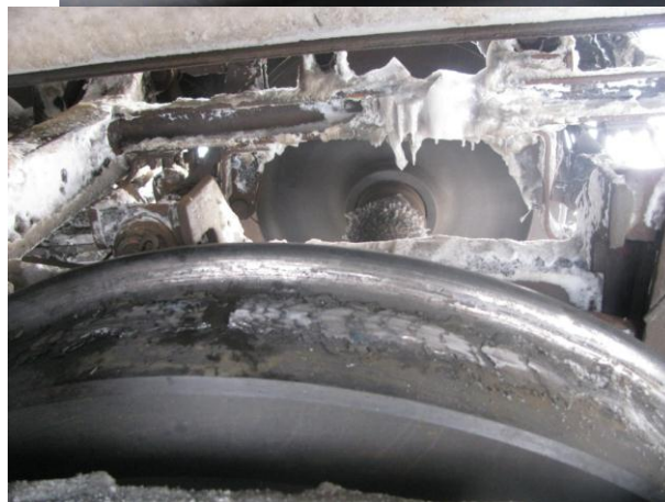
Рис. 4. Утворення наварів на поверхнях кочення колісних пар пасажирського вагона через перезарядку гальмівної магістралі
