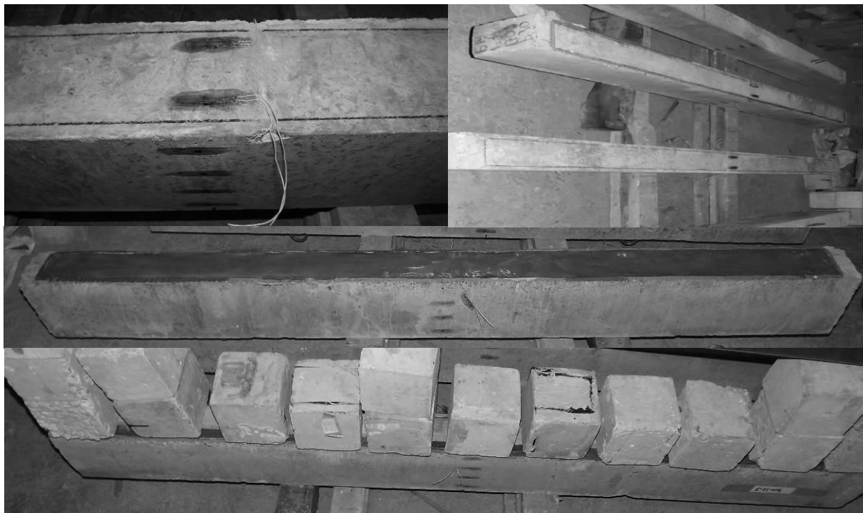
Рис. 1. Технологія влаштування клейового з'єднання зразка Б3
