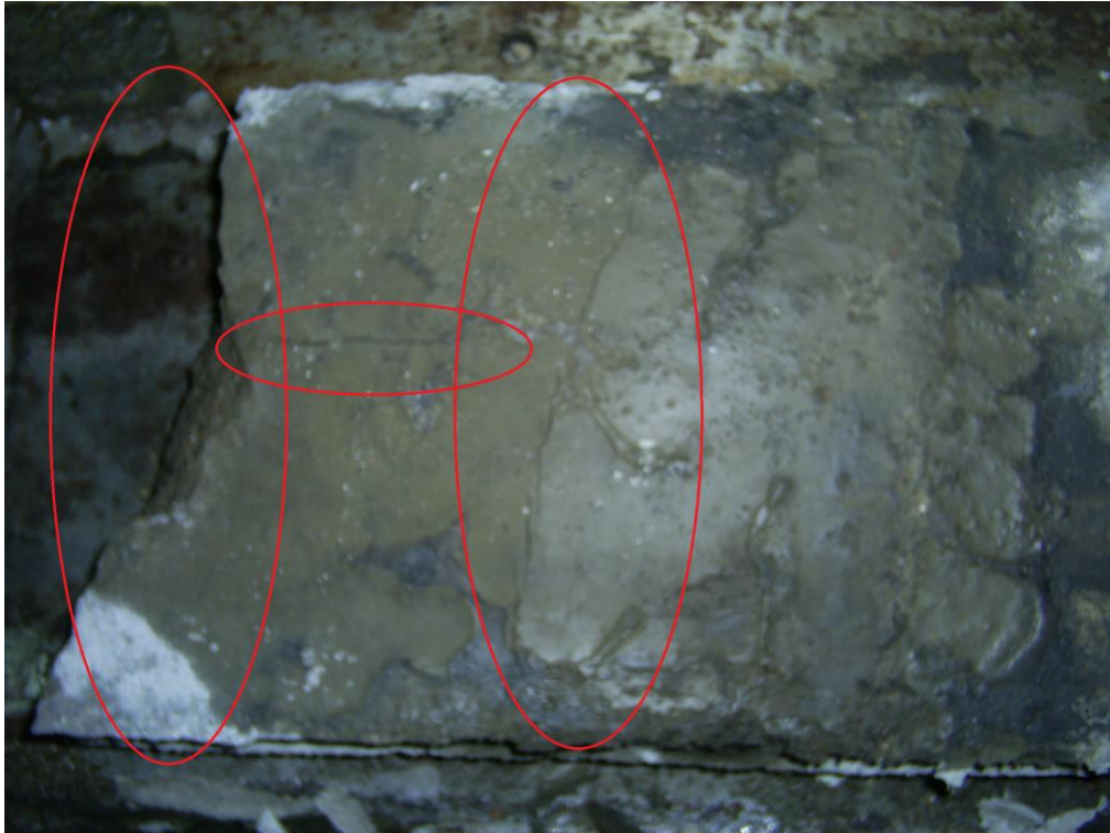
Рис. 5 Поздовжні і поперечні тріщини у прокладному шарі з Emaco Fast Fluid після завершення динамічних випробувань
