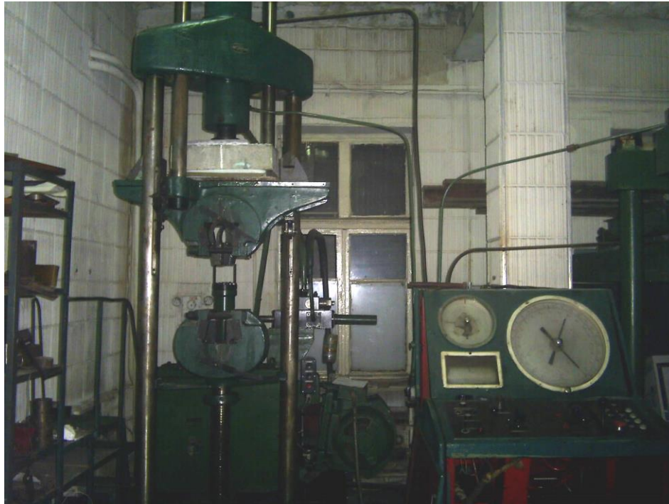
Рис. 1 Динамічні випробування масштабної моделі вузла сполучення верхньої полиці подовжньої балки моста, прокладного шару і плити БМП за допомогою випробувальної машини МУП-50
