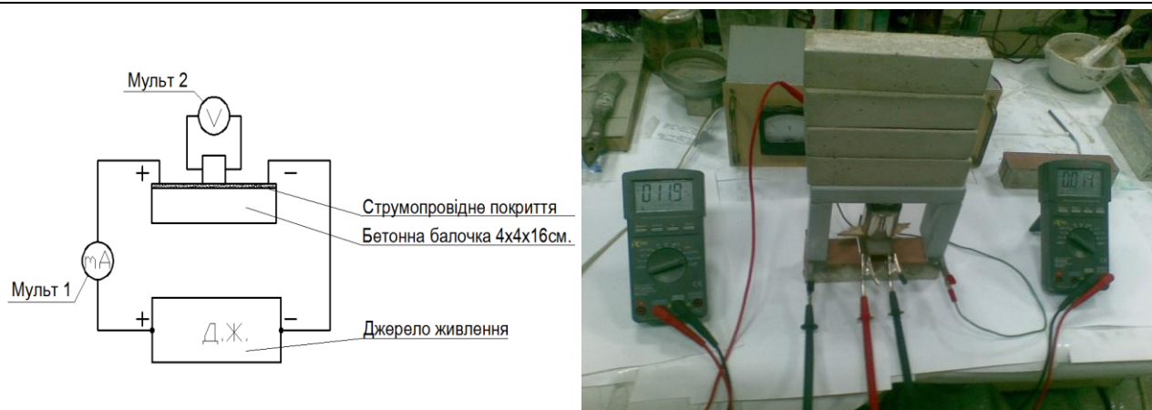
Рис.1. Схема і вигляд установки для вимірювання електричного опору електропровідних покриттів
