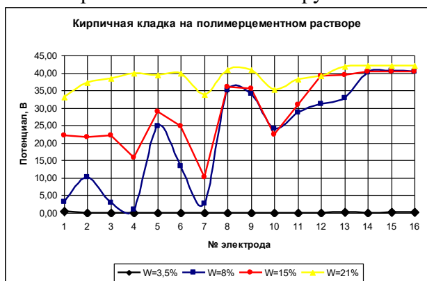
Рис. 6 Потенциалы на электродах образца кирпичной кладки на полимерцементном растворе во время подачи напряжения при различной влажности грунта
