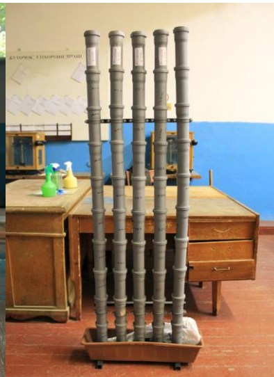
Рис. 2 Трубы, заполненные уплотненным грунтом с обозначением данных сверху по исходной плотности скелета грунта \rho_d и его заданной влажности w
