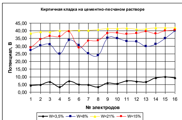
Рис. 4 Потенциалы на электродах образца кирпичной кладки на цементно-песчаном растворе во время подачи напряжения при различной влажности грунта
