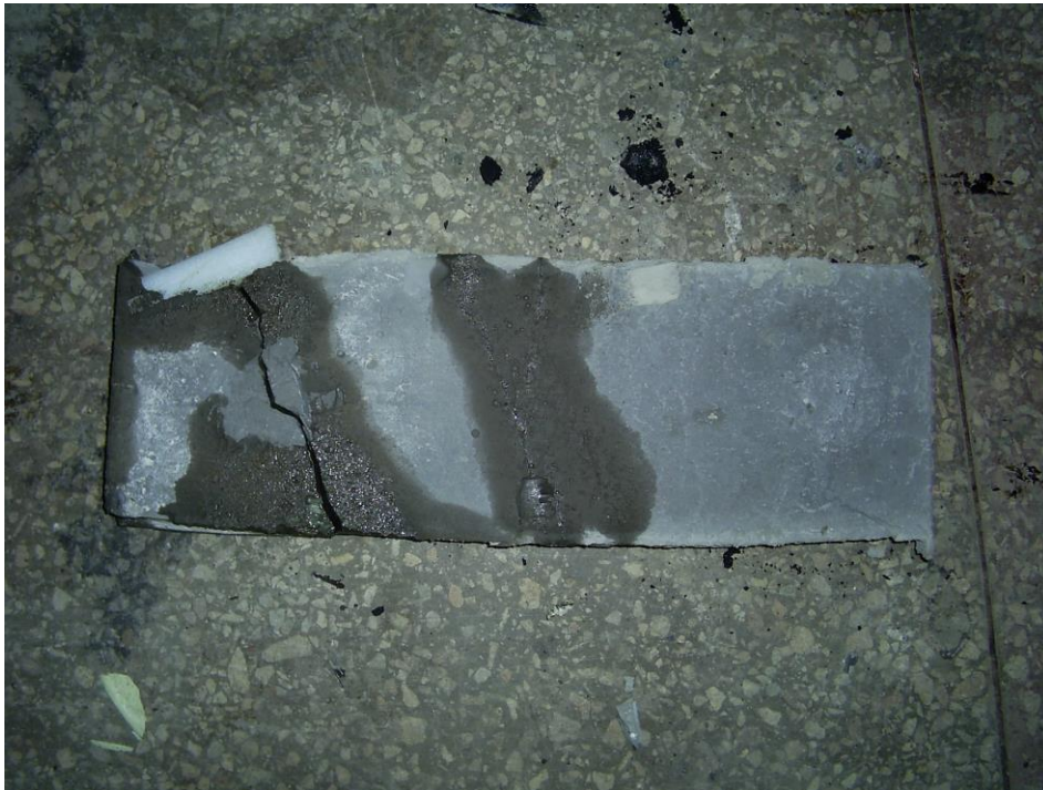
Рис. 7 Прокладний шар із SikaGrout-316 після завершення динамічних випробувань і розбирання моделі: поверхня, контактна з бетоном плити БМП – при розбиранні моделі прокладний шар по наскрізній тріщині розділювався на окремі частини, мастило просочило прокладний шар в районі волосяної тріщини.
