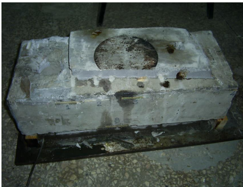
Рис. 9 Прокладний шар із епоксидної композиції Sikadur-42 HE після завершення динамічних випробувань і розбирання моделі
