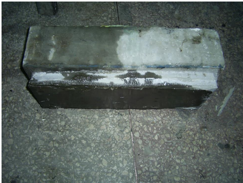
Рис. 6 Прокладний шар із SikaGrout-316 після завершення динамічних випробувань і розбирання моделі: стан добрий, виявлено 2 поперечні тріщини з розкриттям не більше 0,3 мм
