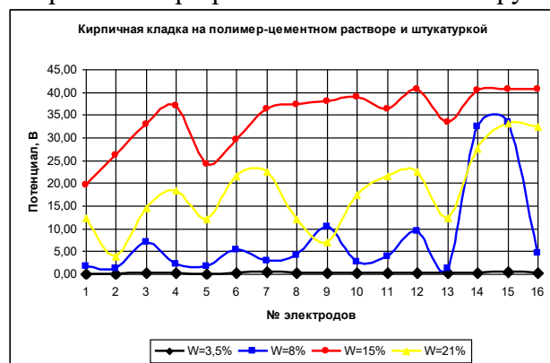
Рис. 7 Потенциалы на электродах образца кирпичной кладки на полимерцементном растворе и штукатурки во время подачи напряжения при различной влажности грунта
