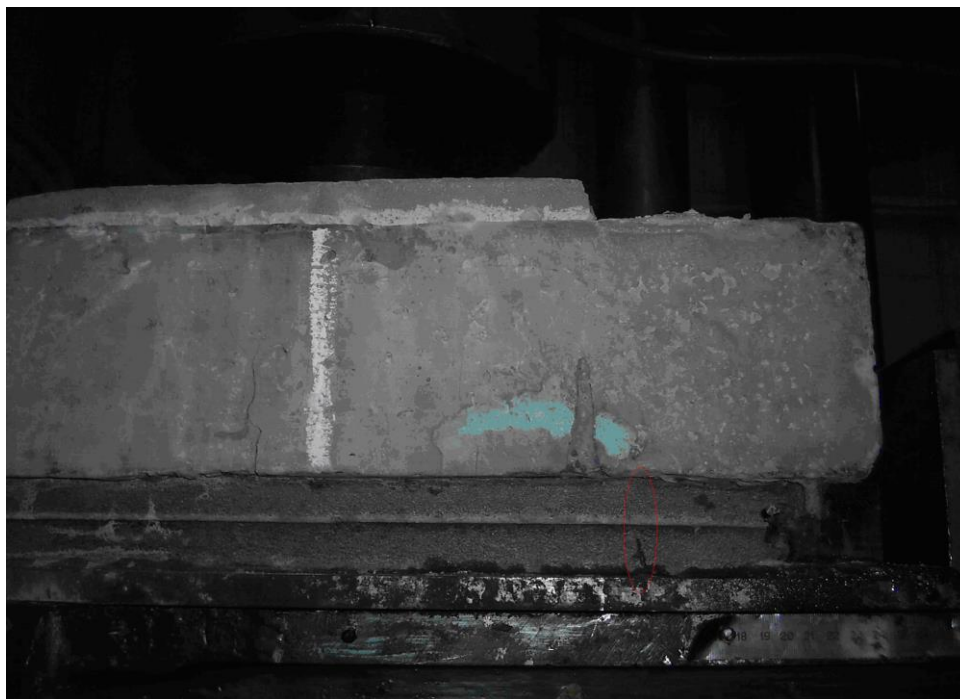
Рис. 2 Утворення у прокладному шарі з Emaco Fast Fluid поперечної тріщини після 376,5 тис. циклів динамічних випробувань
