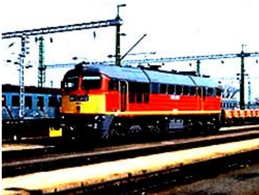
Рис. 1. Тепловоз серії М62 після модернізації
