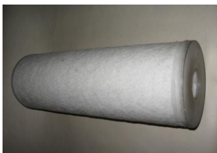
Рис. 1. Синтетичний фільтроелемент ФЕПВ для повнопоточних фільтрів тепловозів
