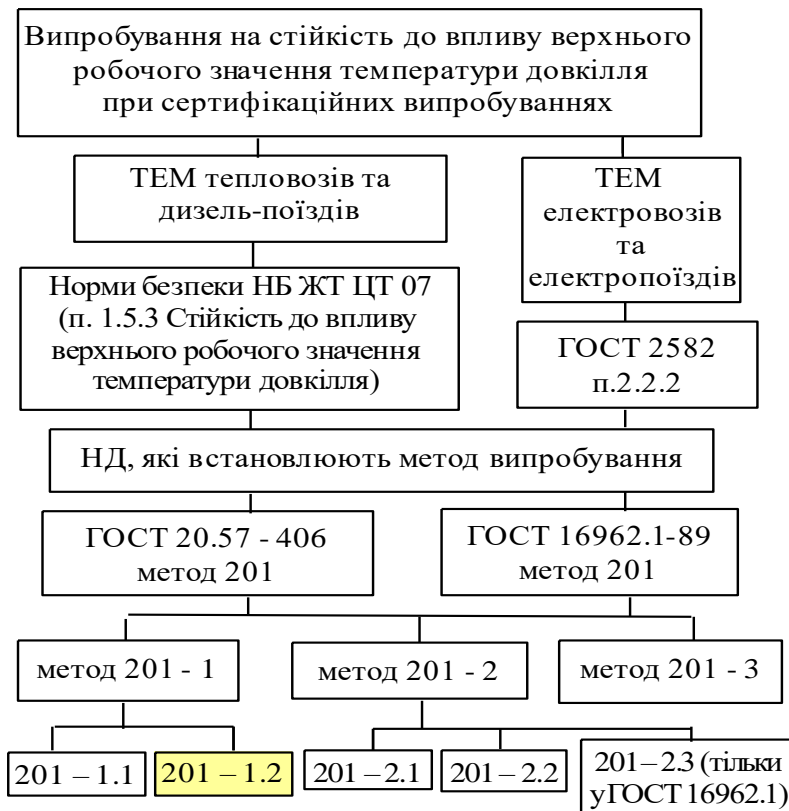
Рис. 1. Схема випробувань ТЕМ за методом 201
