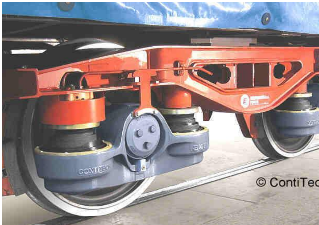
Рис. 2. Тележка Y25 с резино-металлическими рессорами
