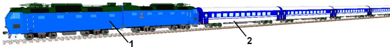
Рис. 1. Динамическая модель пассажирского поезда: 1 – подсистема «Локомотив»; 2 – подсистема «Пассажирский вагон»
