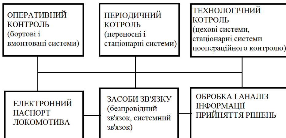
Рис. 1. Трирівнева система діагностування
