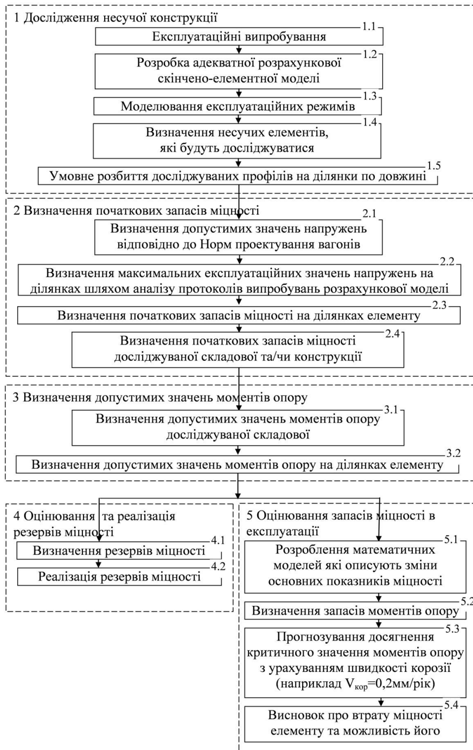
Рис. 1. Алгоритм визначення запасів несучої здатності складових кузовів вантажних вагонів при проектуванні та в експлуатації
