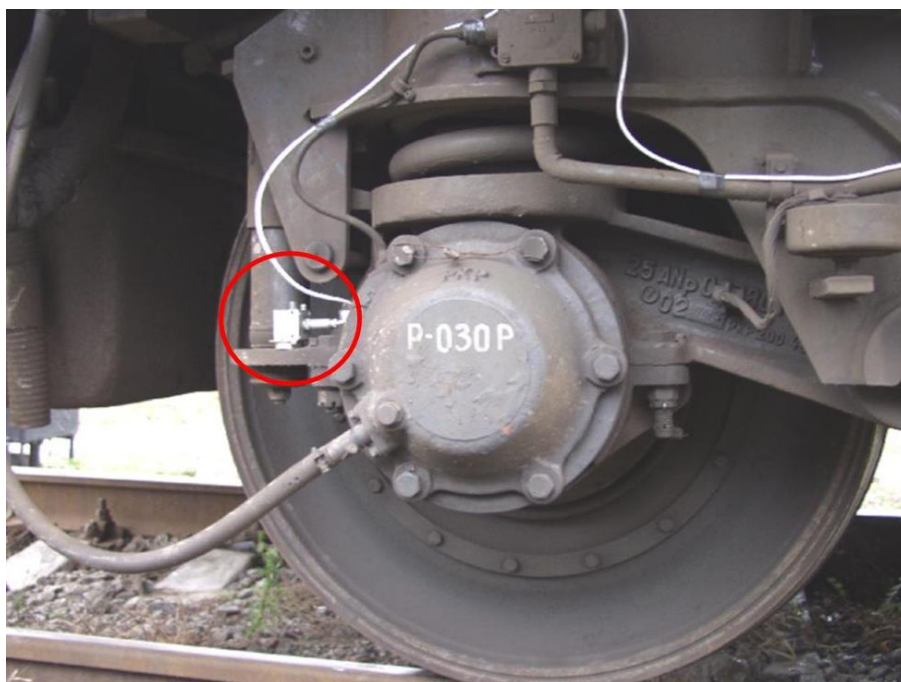
Рис. 2. Ходова частина вагона з п'єзоелектричним датчиком
