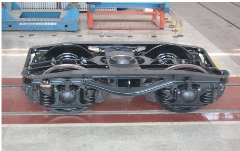
Рис. 1. Тележка Y25 с одноэлементной рамой и металлическими рессорами
