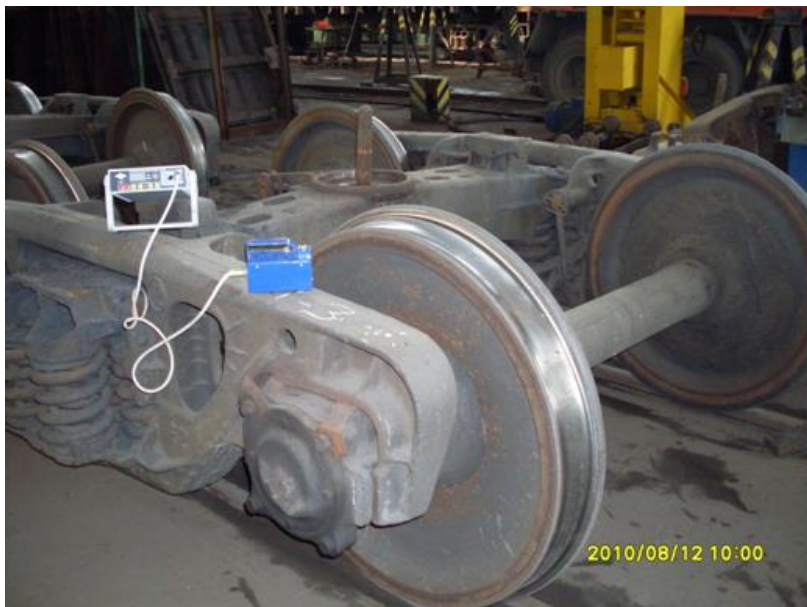
Рис. 1. Вимірювання коерцитивної сили
