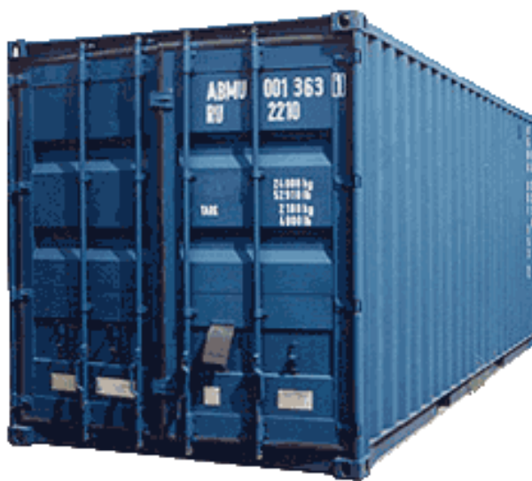
Рис. 1. Контейнер типорозміру 1СС (зовнішній вигляд)
