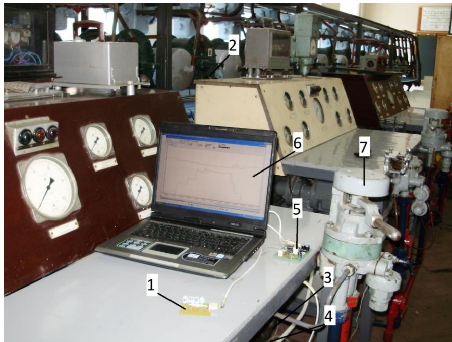
Рис. 3. Прототип системи дистанційного контролю гальм поїздів на базі випробувальної станції кафедри вагонів:
