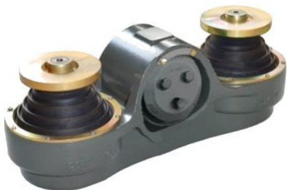
Рис. 3. Буксовый узел тележки
