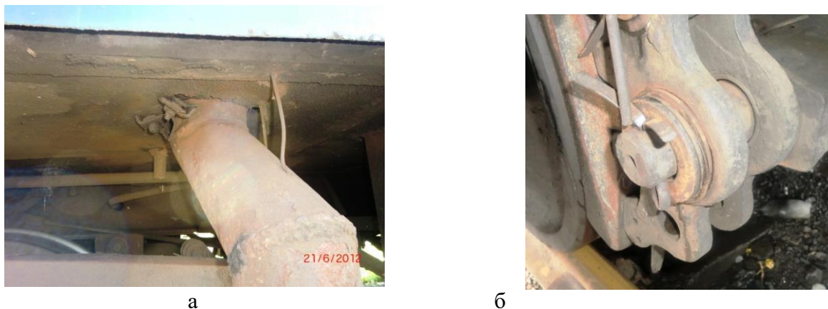
Рис. 4. Незадовільна якість ремонту пасажирських вагонів:
