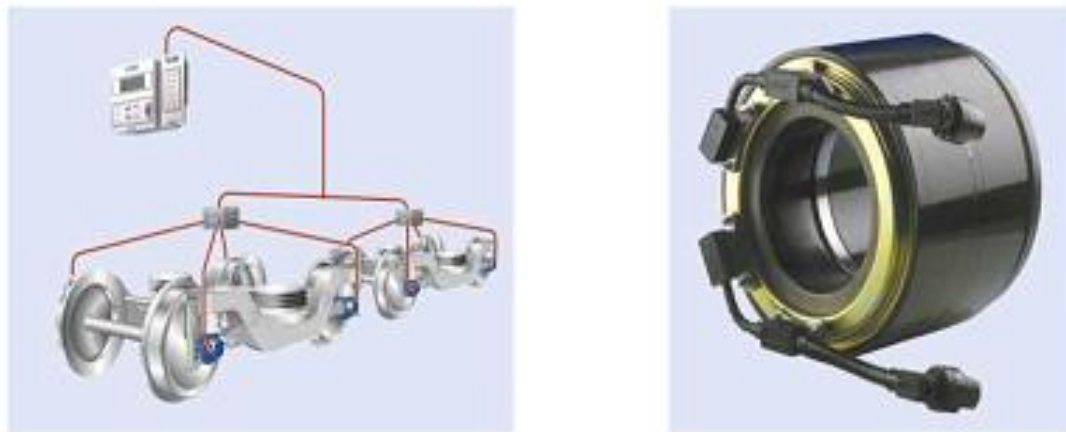
Рис. Принципова схема та зовнішній вигляд підшипникового вузла TBU з вбудованими датчиками
