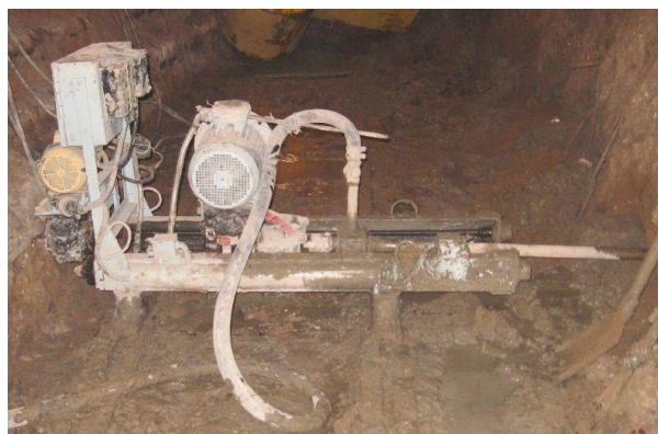
Рис. 4. Верстат для обладнання горизонтальних ґрунтоцементних елементів
