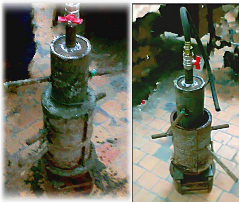
Рис. 1. Разработанная установка для изготовления бетонных цилиндров с полым сечением способом вибровакуумирования
