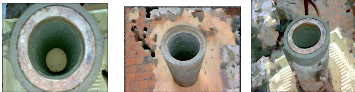
Рис. 2. Полученные образцы бетонных цилиндров с полым сечением
