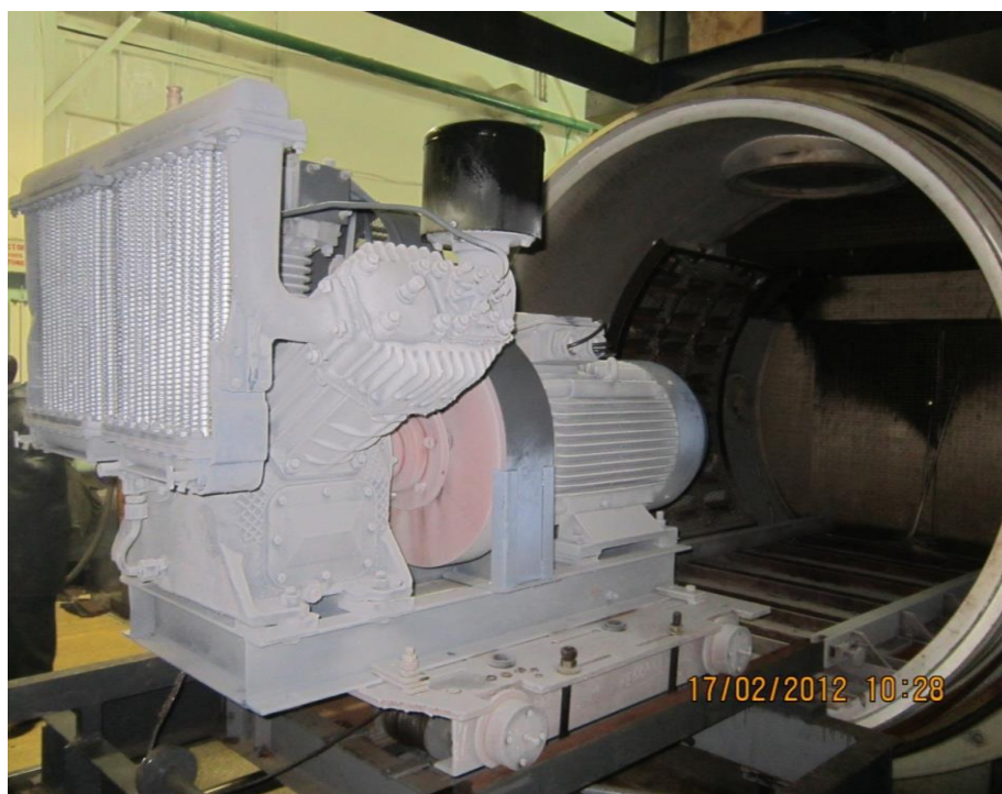
Рис. 1. Климатическая камера для сертификационных испытаний компрессоров (компрессорных агрегатов)
