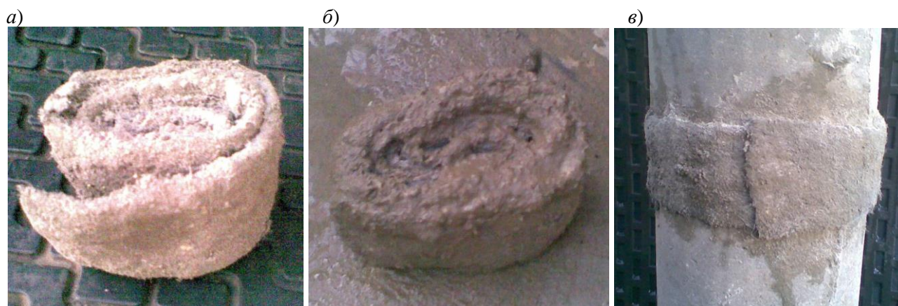
Рис. 1. Рулонный композиционный материал РКМ и его применение: а – рулон; б – водонасыщенный РКМ; в – наклеивание РКМ на поверхность – склейка двух бетонных труб
