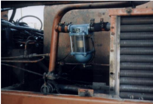
Рис. 16. Пристрій для електростатичної обробки РР в гідросистемі екскаватора EO-3323 (автори розробки – Лисіков Є.М., Косолапов В.Б., Воронін С.В.)
