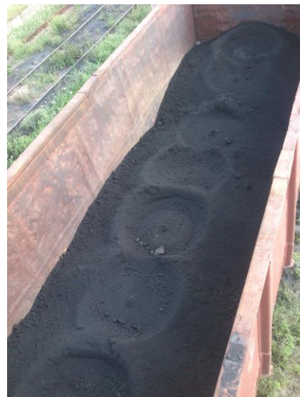
Рис. 5. Вигляд напіввагону з рудним концентратом після обробки роторним розрівнювачем
