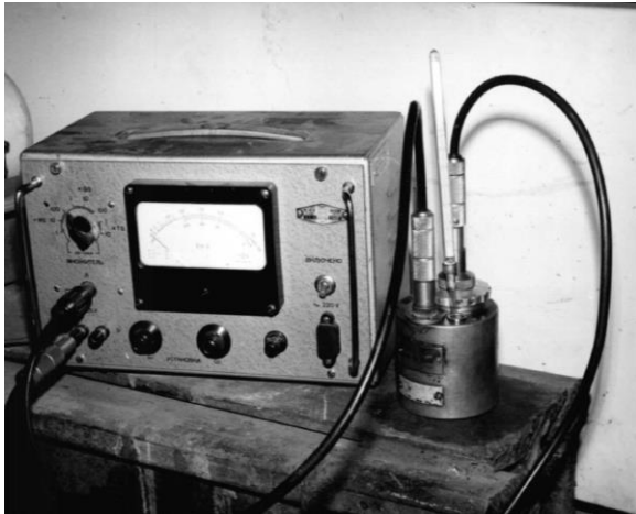
Рис. 13. Стенд для вимірювання забрудненості ПММ (автори розробки – Венцель Є.С., Бабенко А.О.)
