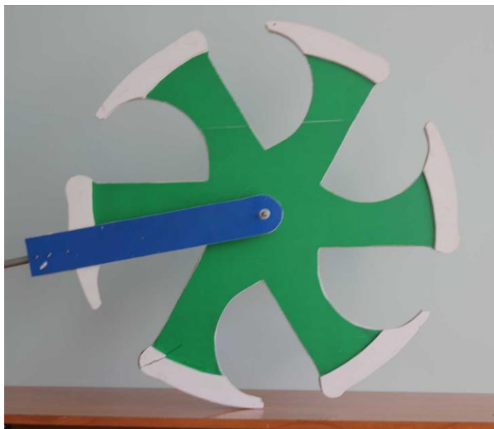
Рис. 5. Лабораторний образец шагающего колеса «тук-тук»
