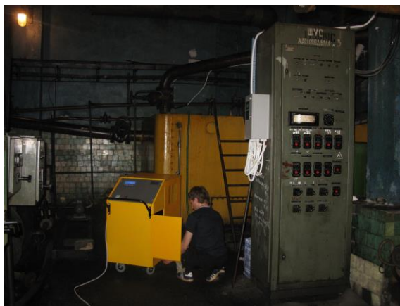
Рис. 18. Мобільна станція для тонкої очистки олив – зліва; уведення станції в експлуатацію на збагачувальній фабриці Полтавського ГЗК – справа (автори розробки – Лисіков Є.М., Косолапов В.Б., Воронін С.В., Літовка С.В.)
