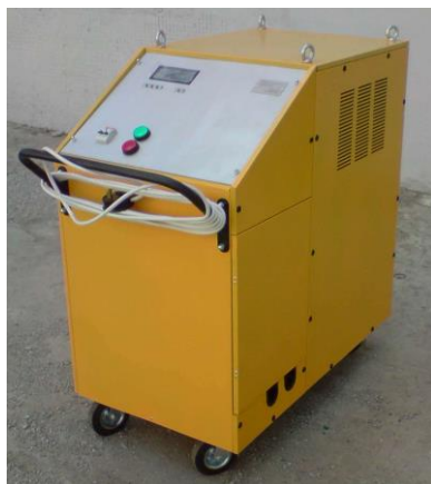
Рис. 18. Мобільна станція для тонкої очистки олив – зліва; уведення станції в експлуатацію на збагачувальній фабриці Полтавського ГЗК – справа (автори розробки – Лисіков Є.М., Косолапов В.Б., Воронін С.В., Літовка С.В.)
