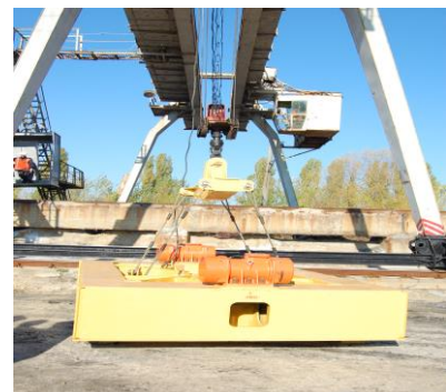
Рис. 7. Накладна вібраційна машина (автори розробки – Романович С.В., Коновалов С.В., Афанасов Г.М., Стефанов В.О.)
