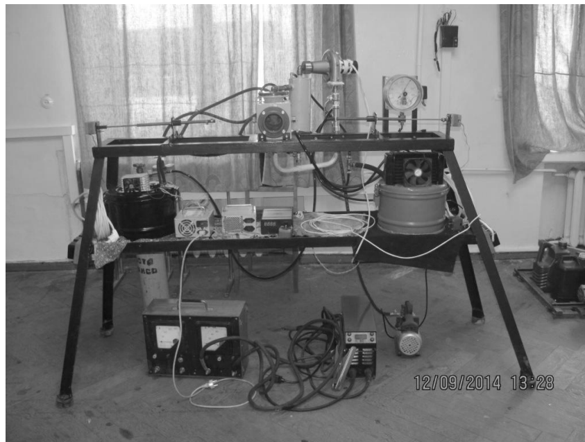
Рис. 20. Стенд для отримання наночастинок вуглецю (автори розробки – Воронін С.В. Суранов О.В., Стефанов В.О., Суранов О.О., Онопрейчук Д.В.)
