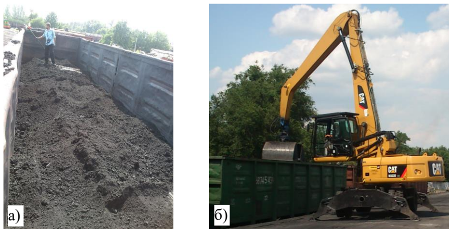
Рис. 2. Найбільш поширені способи розрівнювання насипного вантажу: а – вручну; б – грейфером
