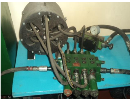
Рис. 10. Перший промисловий зразок гідромотору на основі силових циліндрів (автори розробки – Ремарчук М.П., Воронін С.В., Овсянніков С.І., Чмуж Я.В.)
