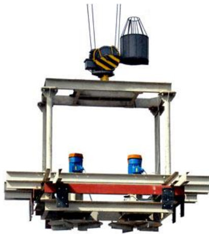
Рис. 4. Роторний навісний пристрій для розрівнювання насипних вантажів у напіввагонах
