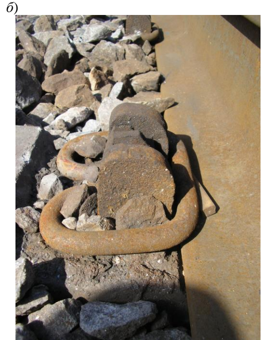
Рис. 5. Анкерне скріплення з високою поперечною жорсткістю АРС-4: a – деталь із з'єднаних скобою анкерів, зафіксована у формі перед формуванням шпал (Белгородський ЗЗБШ, Росія); б, в – характерні пошкодження – руйнування полімерних вкладишів на ділянці Іларионове – Синельникове Придніпровської залізниці
