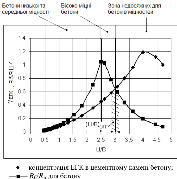
Рис. 8. Графіки залежності концентрації електрогетерогенних контактів ЕГК і відношення R_{\delta}/R_{\text{ц}} від Ц/В для бетону
