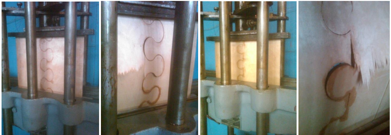
Рис. 10. Разрушение сжато-изгибаемых фанерных пластин
