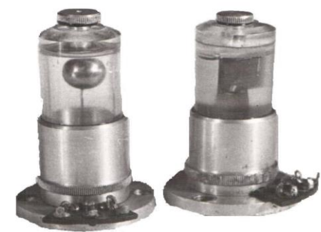
Рис. 1. Вібродатчик ИС-312 С з жидкісним демпфуванням
