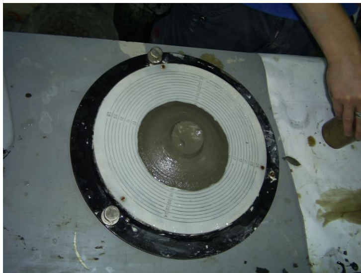
Рис. 1. Визначення розтічності суміші за віскозіметром Сутгарда
