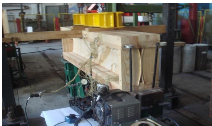
Рис. 2. Экспериментальный образец X-образной балки
