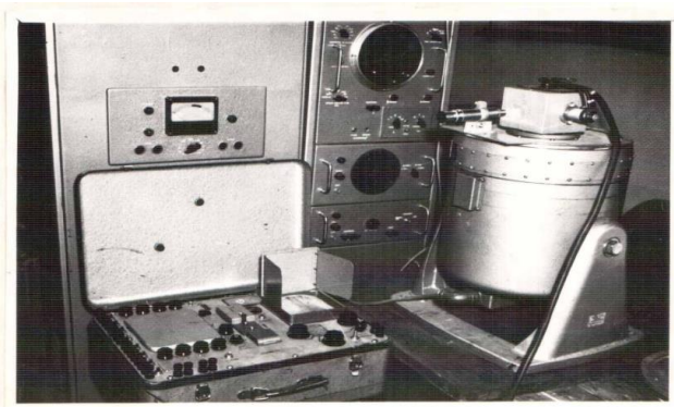
Рис. 2. Вібростенд ВЕД-100 Б
