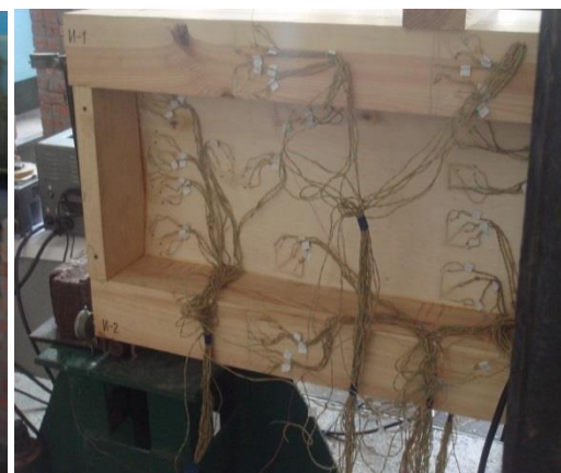
Рис. 2. Экспериментальный образец X-образной балки
