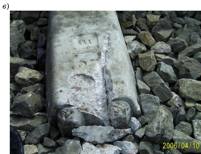
Рис. 4. Характерні пошкодження залізобетонних шпал зі скріпленнями з високою поперечною жорсткістю – подовжні тріщини від анкера до торця шпали: а, б – шпали СБ3-1 зі скріпленням КПП-5; в – шпали зі скріпленням Vossloh W 14 (Литовська залізниця)
