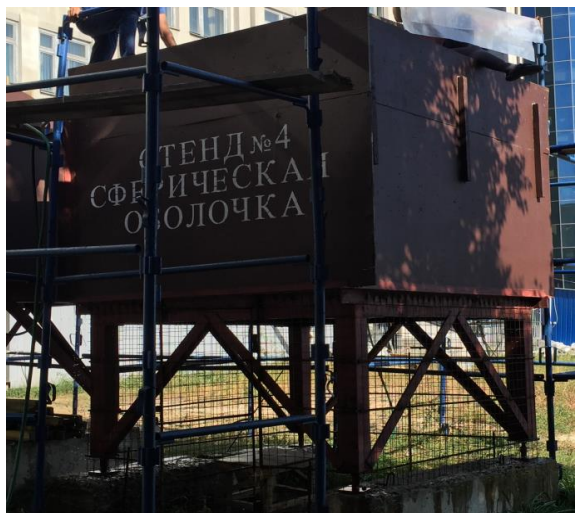
Рис. 4. Стенд для випробовувань сферичної оболонки
