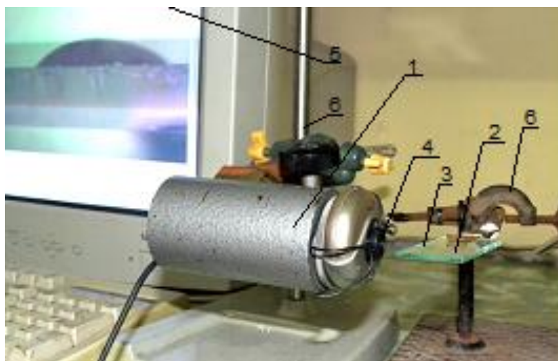
Рис. 1. Схема установки для вимірювання крайового кута: 1 – WEB камера; 2 – змочувана поверхня (скло); 3 – крапля водного розчину з добавкою; 4 – фокус камери; 5 – зображення, що виводиться на екрані; 6 – штатив
