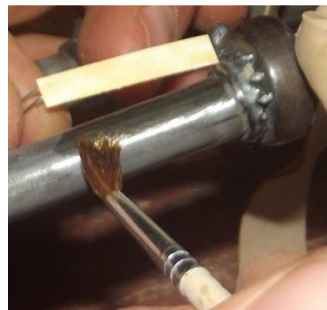
Рис. 5. Схема розташування електротензорезисторів і процес їх фіксації
