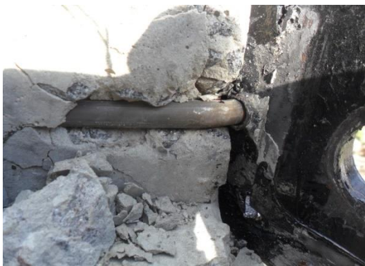
Рис. 9. Загальний вигляд закладної деталі після випробування
