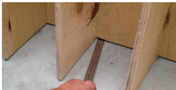
Рис. 12. Установлений проміжок між внутрішніми перегородками басейну та оболонкою
