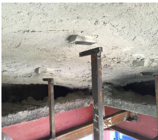
Рис. 6. Конструкція для закріплення індикаторів
