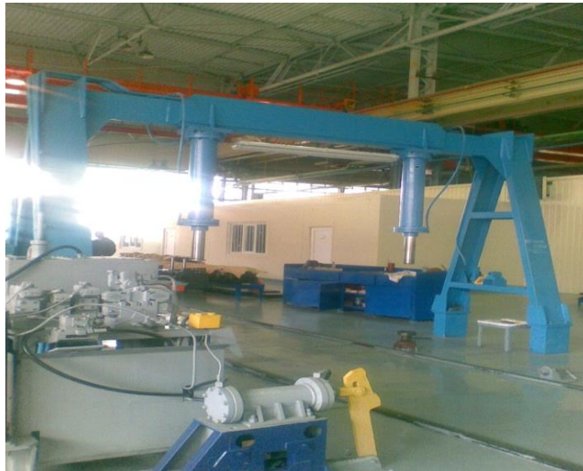
Рис. 2. Стенд для розбирання (складання) візків моделей 68-7007 і 68-7012(13)
