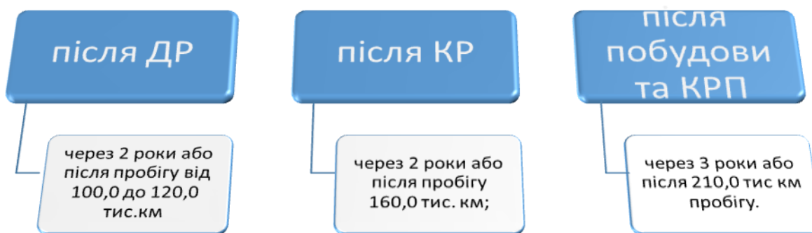
Рис. 1. Нормативи надходження до ремонту переважної більшості вантажних вагонів (планово-попереджувальна система ремонту)
