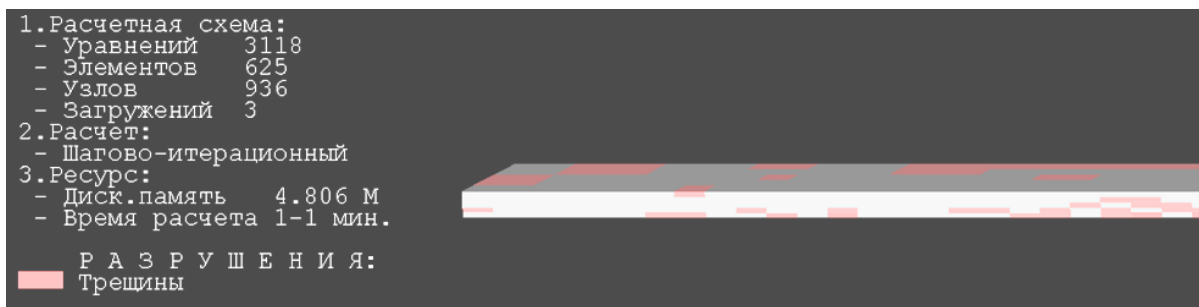
Рис. 7. Картина разрушения. Локальное загрузеие 3, шаг 15
