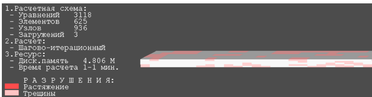
Рис. 8. Картина разрушения. Локальное загрузеие 3, шаг 18
