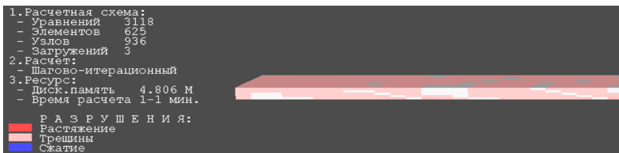
Рис. 9. Картина разрушения. Локальное загрузеие 3, шаг 42
