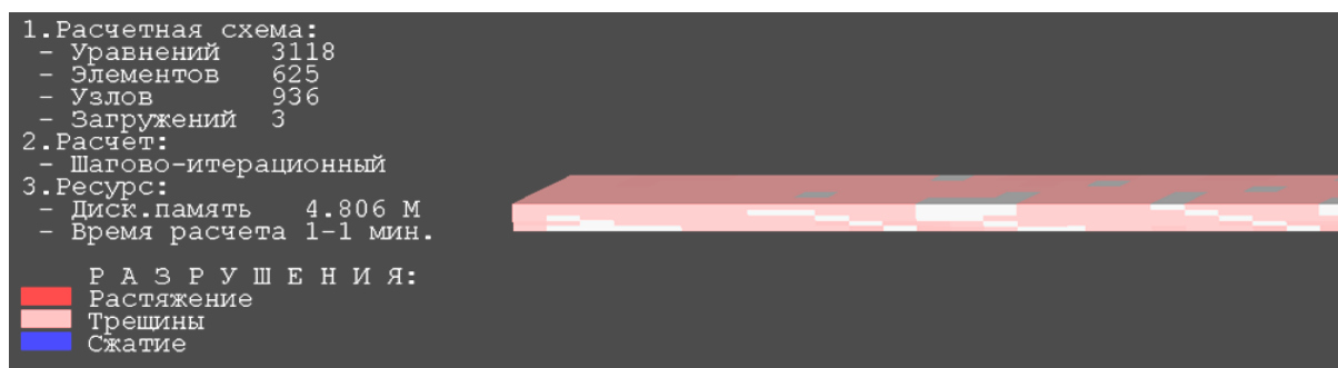
Рис. 10. Картина разрушения. Локальное загрузеие 3, шаг 49
