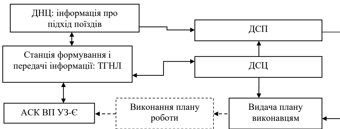
Рис. 2. Схема одержання інформації і планування роботи станції Кривий Ріг - Головний
