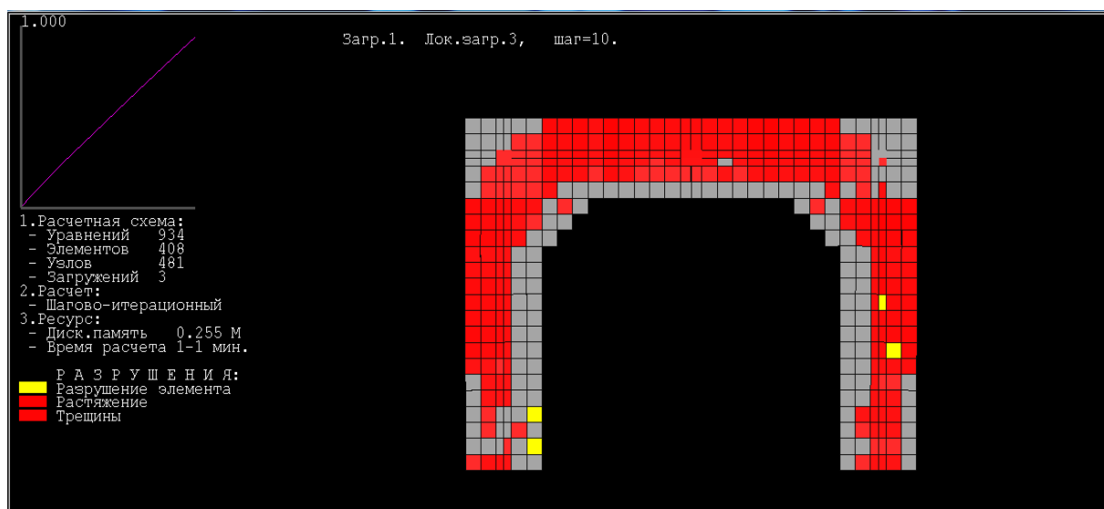
Рис. 16. Картина разрушения на 10 шаге локального нагружения 3 от нагрузки и температурного воздействия
