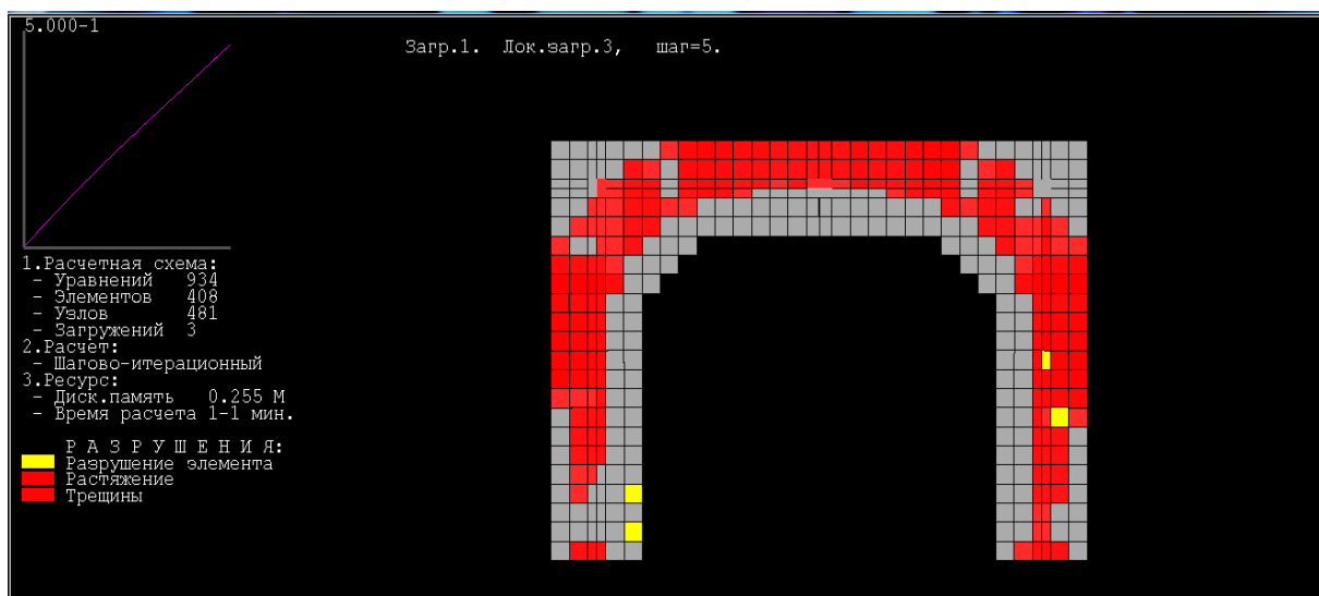
Рис. 15. Картина разрушения на 5 шаге локального нагружения 3 от нагрузки и температурного воздействия
