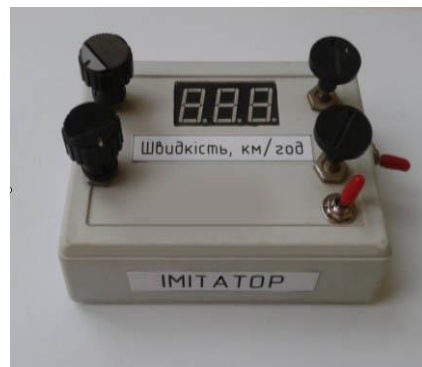
Рис. 1. Макетний зразок пристрою акустичного контролю та імітатор звука взаємодії колеса з рейкою
