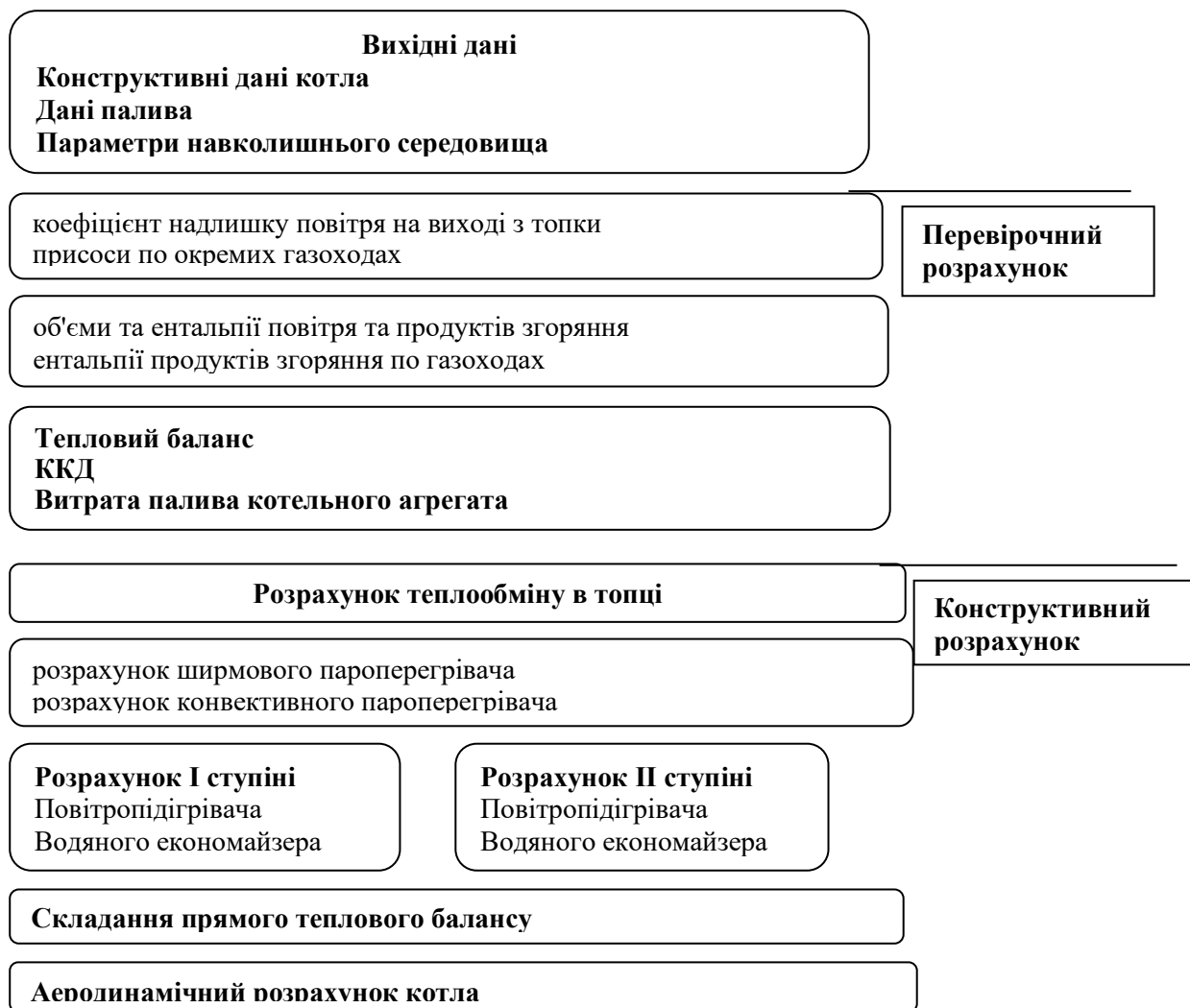
Рис. 1. Алгоритм розрахунку теплового балансу згідно з Нормативним методом
