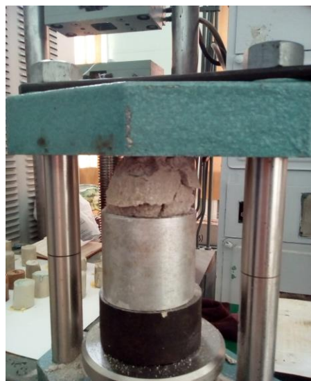
Рис. 2. Испытания грунта на сжатие: а – образцы грунта перед испытанием; б – образец грунта в прессе в процессе испытания; в – образец грунта после проведения испытания
