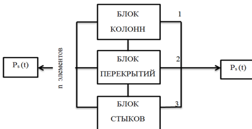
Рис. 2. Модель соединения группы основных несущих элементов многоэтажного каркасного здания ( n=3 )
