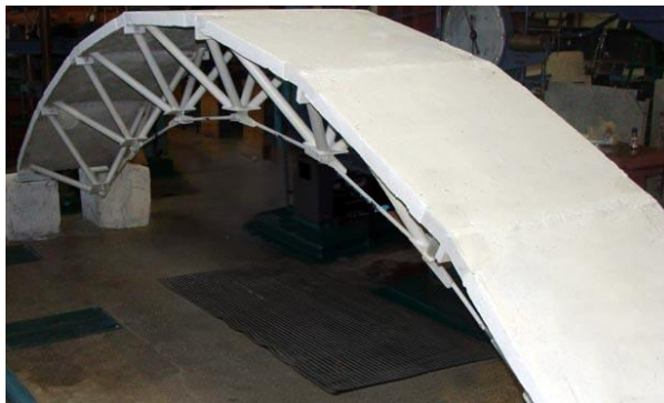
Рис. 9. Просторова структурно-вантова сталезалізобетонна конструкція в змонтованому стані
