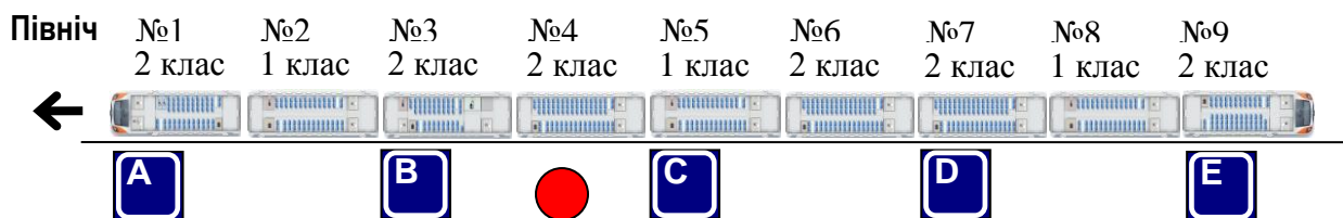
Рис. 3. Приклад діаграми схеми формування швидкісного пасажирського поїзда класу “Інтерсіті+” компанії Hyundai Rotem (серія HRCS2)
