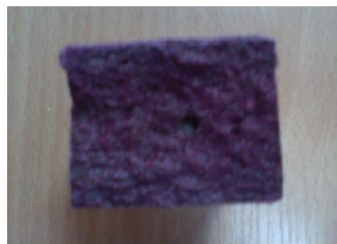
Рис. 3. Фотографії поверхні зламу зразків дрібнозернистого бетону, просочених розчином фенолфталеїну: а – без нанесення гідроізоляційного покриття; б – з нанесеним гідроізоляційним покриттям
