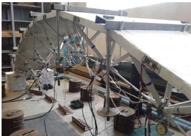
Рис. 10. Розміщення траверс, через які прикладалося навантаження
