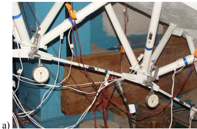
Рис. 11. Розміщення обладнання для вимірювання переміщень у вузлах нижнього пояса (а) та опорних вузлах (б)
