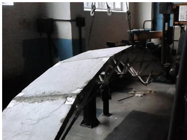
Рис. 8. Просторова структурно-вантова сталезалізобетонна конструкція в процесі монтажу
