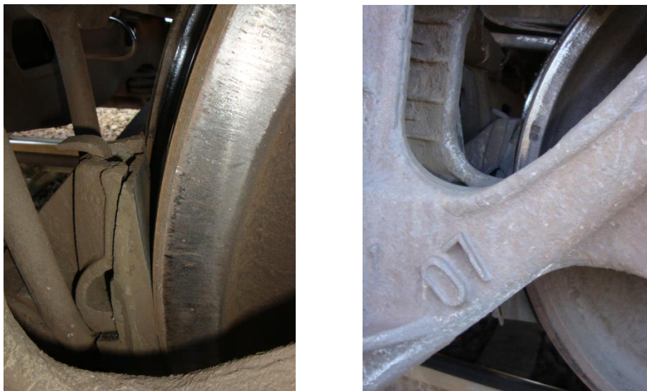
Рис. 1. Клиноподібно зношені гальмівні колодки вагонів
