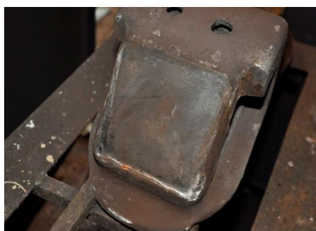
Рис. 1. Чугунные клинья с износами наклонной и вертикальной поверхности, подлежащие выбраковке при проведении планового ремонта
