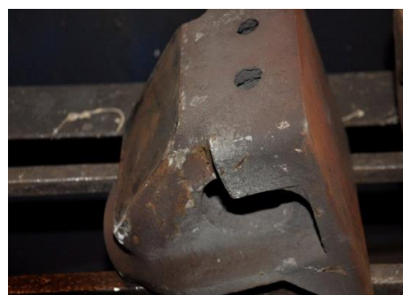
Рис. 1. Чугунные клинья с износами наклонной и вертикальной поверхности, подлежащие выбраковке при проведении планового ремонта
