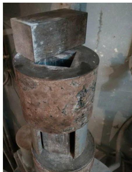
Рис. 5. Прес-форма для формування зразків
