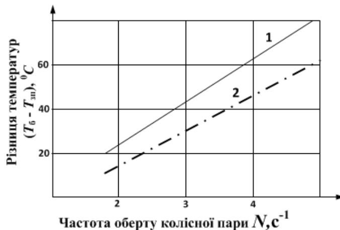
Рис. 1. Діаграма залежності температури букси від частоти обертання колісної пари: 1 – для завантажених вантажних вагонів; 2 – для пасажирських вагонів; (T_b - T_{zn}) – різниця температур між буксою та зовнішнім повітрям
