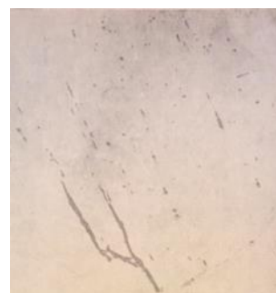
Рис. 6. Розвиток розгалуженої поздовжньої тріщини по неметалевих вкрапленнях
