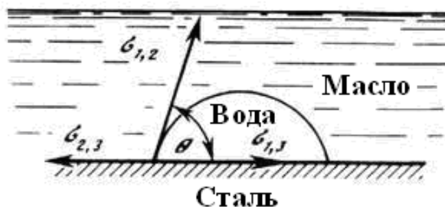
Рис. 2. Форма капли, обусловленная поверхностными натяжениями на различных границах соприкасающихся фаз
