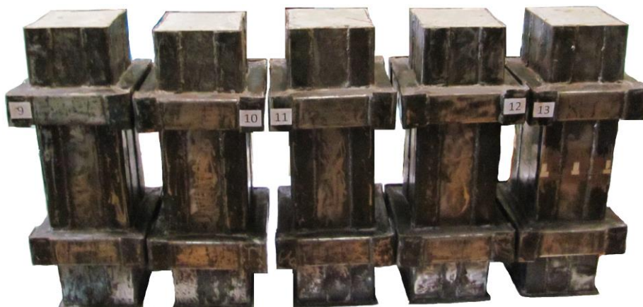
Рис. 1. Внешний вид сталебетонных элементов перед испытанием
