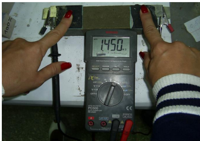
Рис. 2. Схема вимірювання електроопору за допомогою Sanwa – PC50
