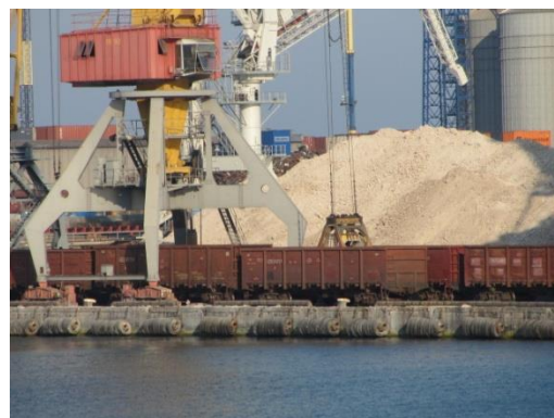
Рис. 3. Кінцева стадія розвантаження НПВ: а – грейфер над кузовом; б – грейфер на підлозі кузова
