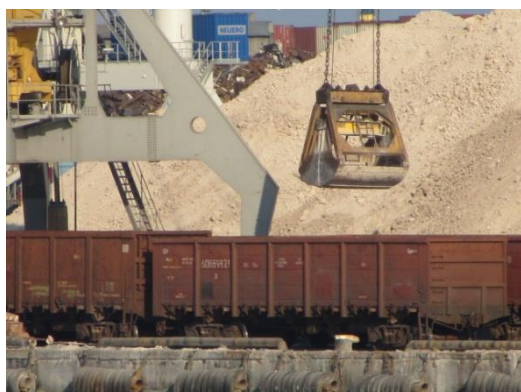
Рис. 3. Кінцева стадія розвантаження НПВ: а – грейфер над кузовом; б – грейфер на підлозі кузова
