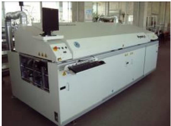
Рис.1 – Обладнання для SMD-монтажа мікроелектронних елементів МПЦ
