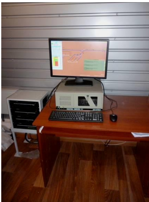
Рис.2 – Діагностичний центр МПЦ - автоматизироване робоче місце електромеханіка СЦБ (АРМ ШН) та постове обладнання гучномовного зв'язку станції «Інженерна»
