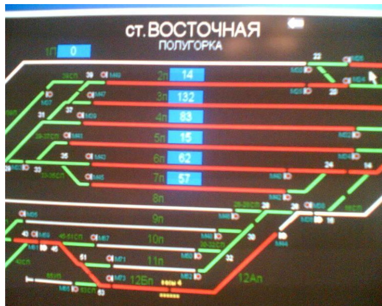
Рис.3. Комп'ютерна система диспетчерського контролю станції «Східна»
