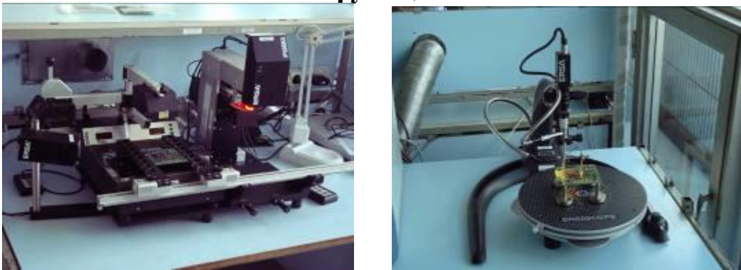
Рис. 2 - Обладнання для монтажу та контролю якості пайки мікросхем у BGA-корпусах.
