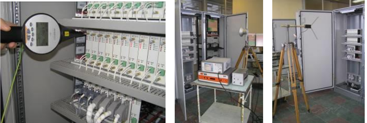
Рис.1. Випробовування, доказ функційної безпечності та електромагнітної сумісності
