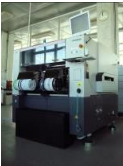
Рис.1 – Обладнання для SMD-монтажа мікроелектронних елементів МПЦ
