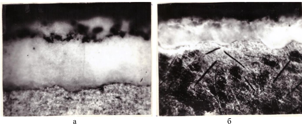
Рис. 2. Покриття на сплаві АК7 (x 200): електроліти: а – 2 г/л КОН + 12 г/л \text{Na}_2\text{SiO}_3 , \tau = 3 год; б – 1 г/л КОН + 6 г/л \text{Na}_2\text{SiO}_3 , \tau = 2 год
