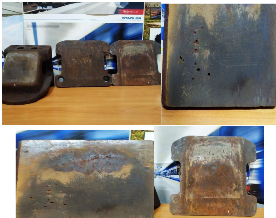
Рисунок 1.9 – Дефекти, які виникають при роботі фрикційного клину
