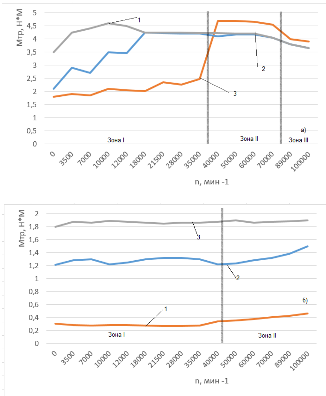
Рисунок 3.26 – Залежність моменту сили тертя від нароблених при сухому (а) та граничному (б) терті в різних зонах покриття ( n – частота оберту): 1 – поверхні тіла і контролеру з композиційним покриттям; 2 – композиційне покриття на поверхні одного з тіл пари тертя; 3 – поверхні тіла та контролеру з покриттям TiN
