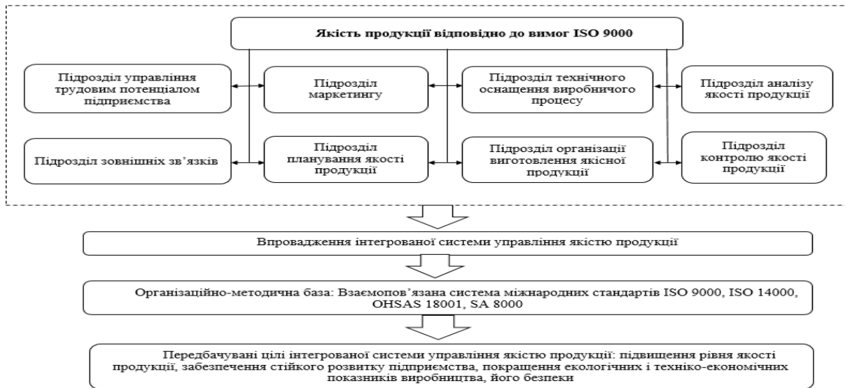
Рис. 1. Інтегрована система управління якістю продукції вітчизняних промислових підприємств залізничного транспорту
