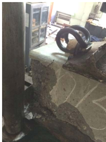
Рис. 4.15. Зразки – блоки підрейкової основи після динамічних випробувань із бетону з коефіцієнтом розсунення зерен крупного \alpha та дрібного \mu заповнювача, відповідно: a – 1,37, 1,36; б – 1,25, 1,21; в – 1,25; 1,30
