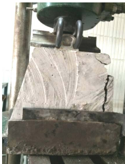
Рис. 4.15. Зразки – блоки підрейкової основи після динамічних випробувань із бетону з коефіцієнтом розсунення зерен крупного \alpha та дрібного \mu заповнювача, відповідно: a – 1,37, 1,36; б – 1,25, 1,21; в – 1,25; 1,30
