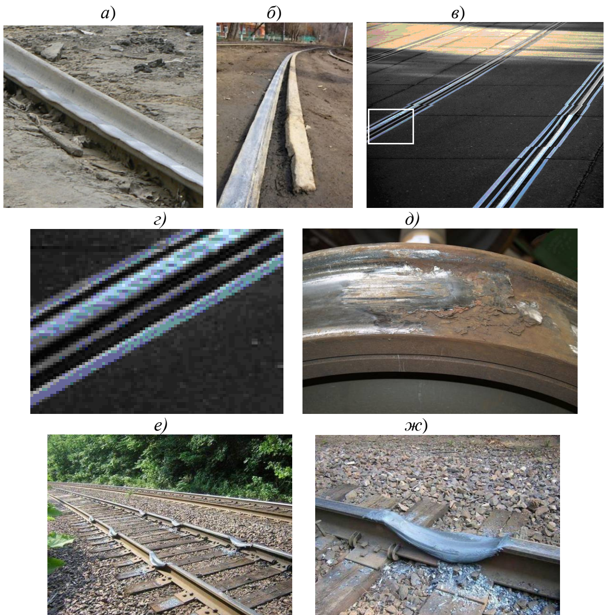
Рис. 1.8. Хвилеподібний знос рейки та пошкодження від боксування: a – хвилеподібний знос по вертикалі [41]; б – хвилеподібний знос по горизонталі [60]; в, г – хвилеподібний знос в колії на залізобетонних плитах [57]; д – гальмівний повзун на колесі [61]; е, ж – пошкодження рейок від боксування [62 – 64]
