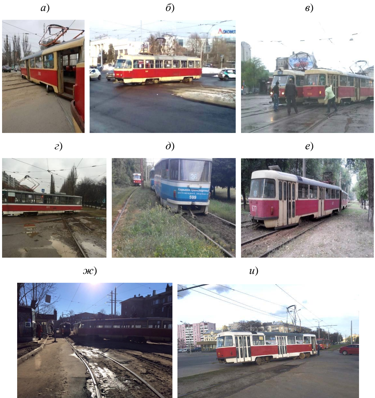
Рис. А.1. Характерні сходи трамваїв з рейок у м. Харків (табл. А.1) : a – 9, значних пошкоджень колії не видно; б – 13, на перехресті у кривій; в – 44; г – 79; д – 95, помітних пошкоджень колії немає; е – 96, помітних пошкоджень колії немає; ж – 106, видно обводнене поглиблення між рейками; и – 7, видно обводнене поглиблення між рейками
