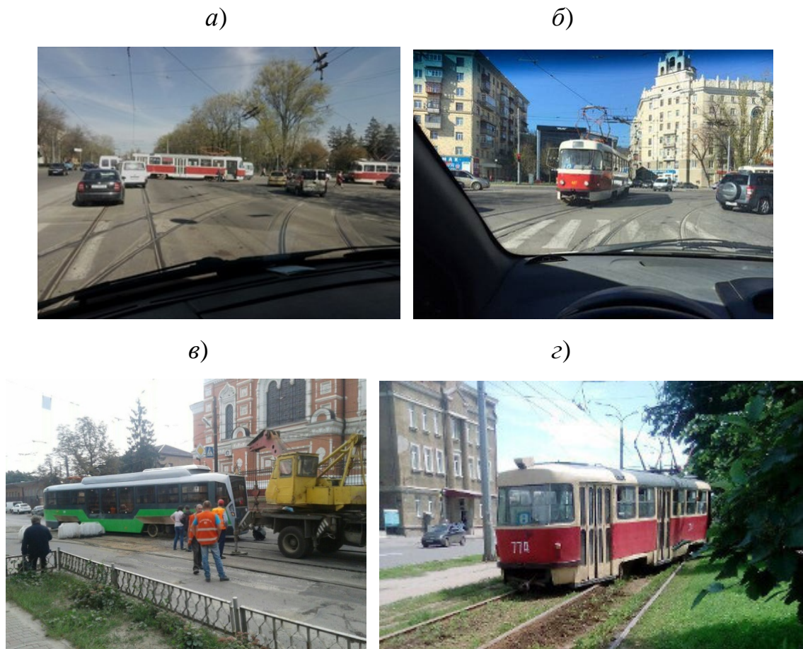
Рис. А.2. Характерні сходи трамваїв з рейок у м. Харків (табл. А.1): а – 3; б – 27; в – 15; з – 39, помітних пошкоджень колії немає. Особливості місць сходів – перехрестя, криві. Можливий горизонтальний вплив електричних сил
