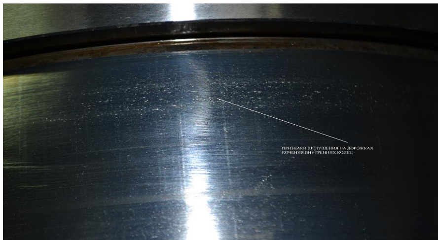
Рис. 2. Сліди луцення металу на дорожках кочення внутрішнього кільця
