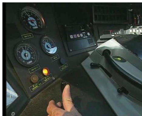
Рис. 1. Тестування систем (а) і перевірка гальм (б) при прийманні високошвидкісного поїзда TGV
