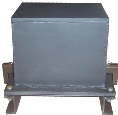
Рис. 1. Розроблений навігаційний пристрій GPS вантажного вагона
