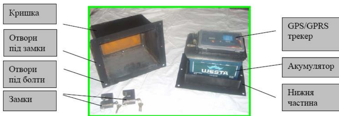
Рис. 2. Елементна база навігаційного пристрою GPS
