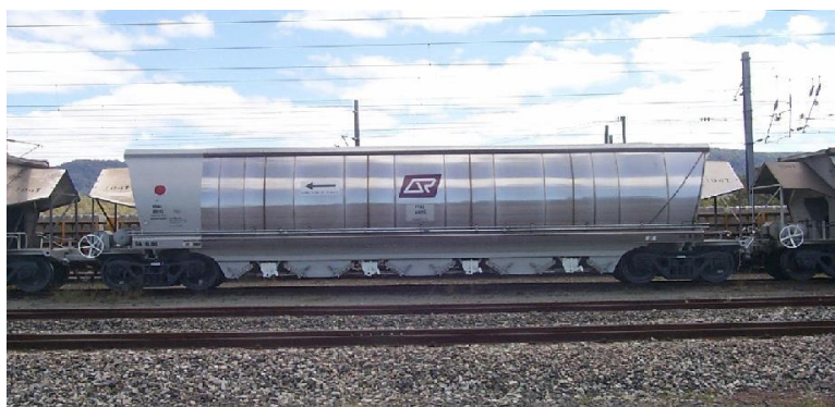
Рис. 3. Вагон австралійських залізниць, обладнаний підшипниковим вузлом з дворядним касетним конічним підшипником (осьове навантаження 270 кН)
