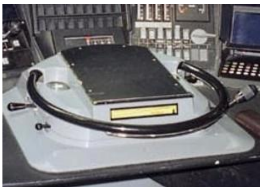
Рис. 4. Селектори тяги поїзда TGV з рульовим керуванням (а) і важільного типу (б)
