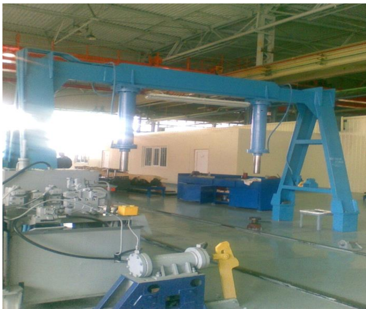
Рис. 2. Стенд для розбирання (складання) візків моделей 68-7007 і 68-7012
