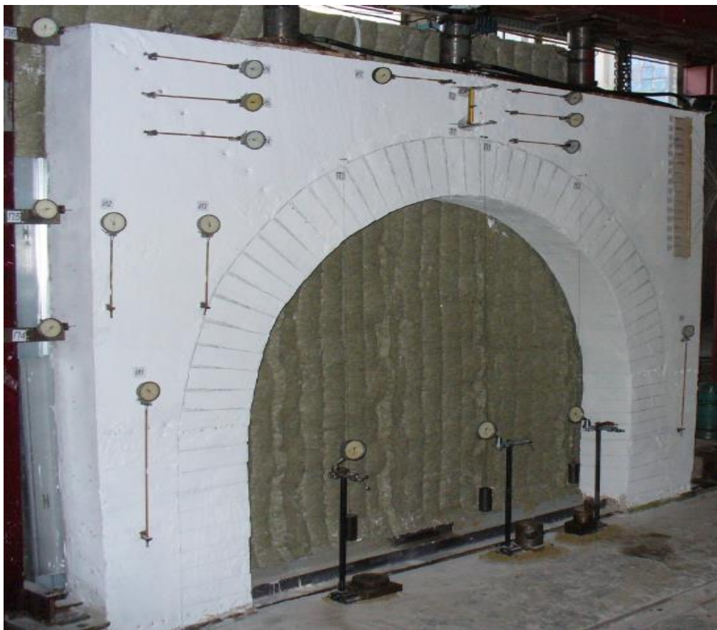
Рис. 5. Загрузка фрагмента фундамента №1 с футеровкой борова
