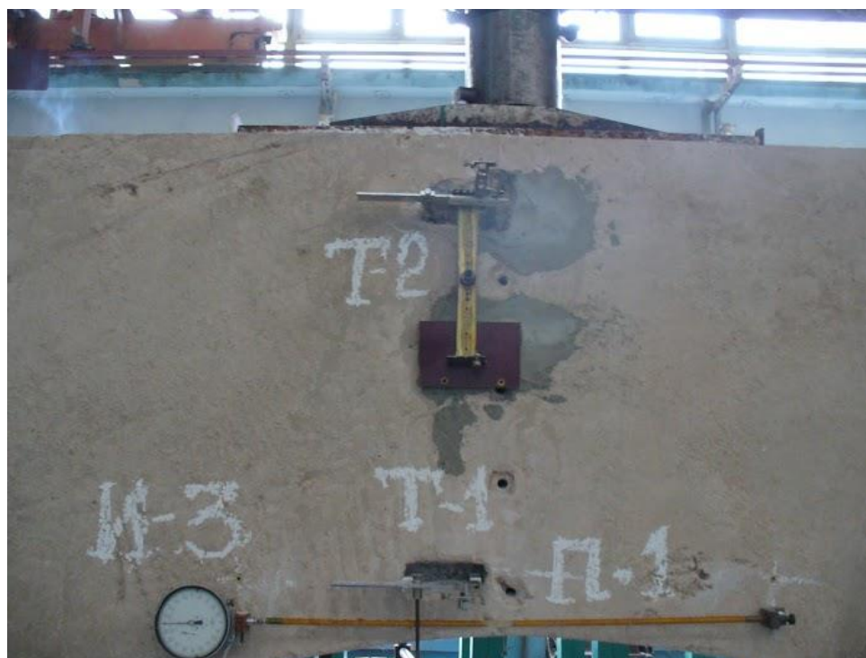
Рис. 9. Установка рычажных тензметров Т1-Т2 на верхней и нижней арматуре
