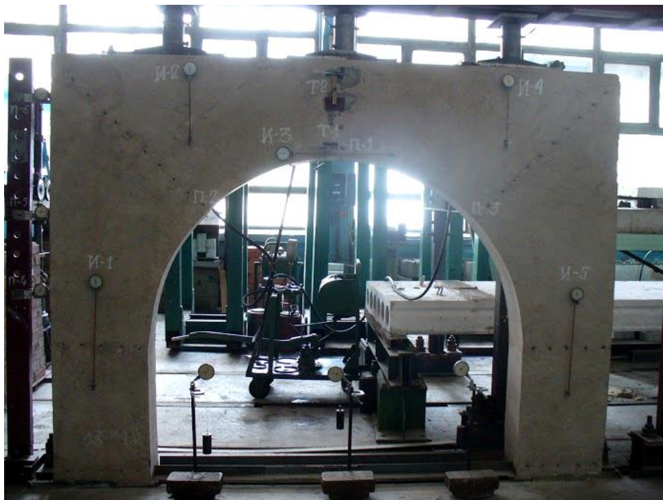
Рис. 8. Расстановка индикаторных тензметров И1-И5 на бетон, рычажных тензметров Т1-Т2 на верхней и нижней арматуре и прогибомеров П1-П6 в железобетонном фрагменте фундамента №2 без футеровки борава
