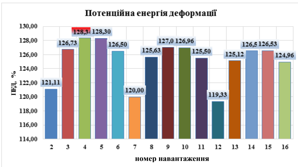
Рис. 7. Ранжування значень потенційної енергії деформації для температурного навантаження
