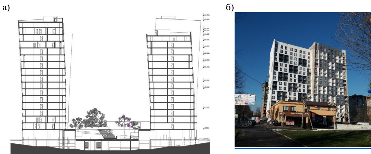
Рис. 1. Поперечний переріз (а) та фото реалізованих (б) розглянутих будівель ЖК «Америка»
