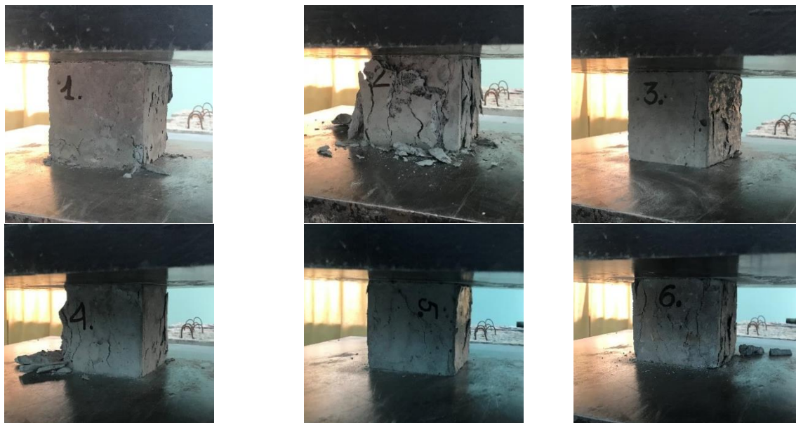
Рис. 6. Стандартні випробування з визначення кубикової міцності бетону на стиск у пресі ПСУ-250
