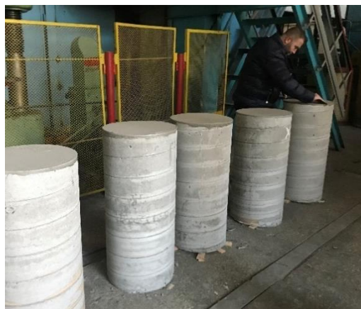
Рис. 3. Загальний вигляд бетонних зразків до (зліва) та після (справа) видалення картонної опалубки
