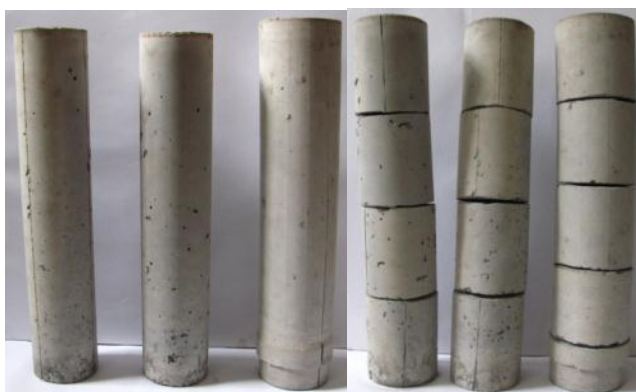
Рис. 3.6. Бетонні циліндри для дослідження однорідності бетонної суміші
