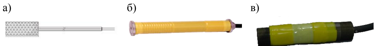
Рис. 1.3. Закладні тензодатчики деформацій: а – тензорезистори серії КМ-30-120-Н1, б – датчик деформацій в бетоні BS-25АТ/ВТ, в – датчик деформацій в бетоні BS-8FT (малогабаритний)
