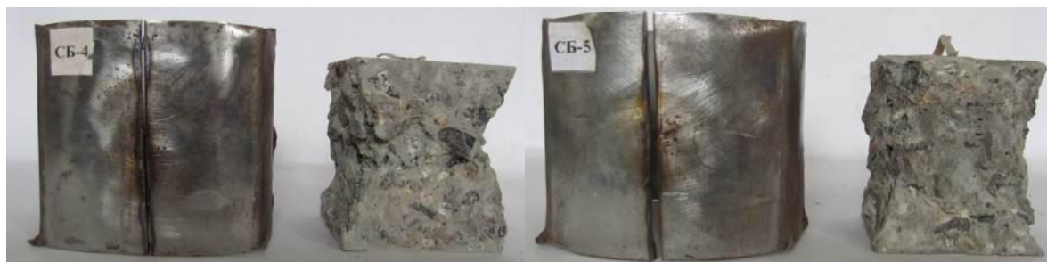
Рис. 3.10. Зовнішній вигляд сталобетонних кубиків після демонтажу обойми: навантаження на комплексний переріз (а) та навантаження на бетон (б)
