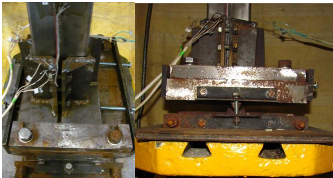
Рис. 3.21. Загальний вигляд ножового шарніра з опорним бандажем
