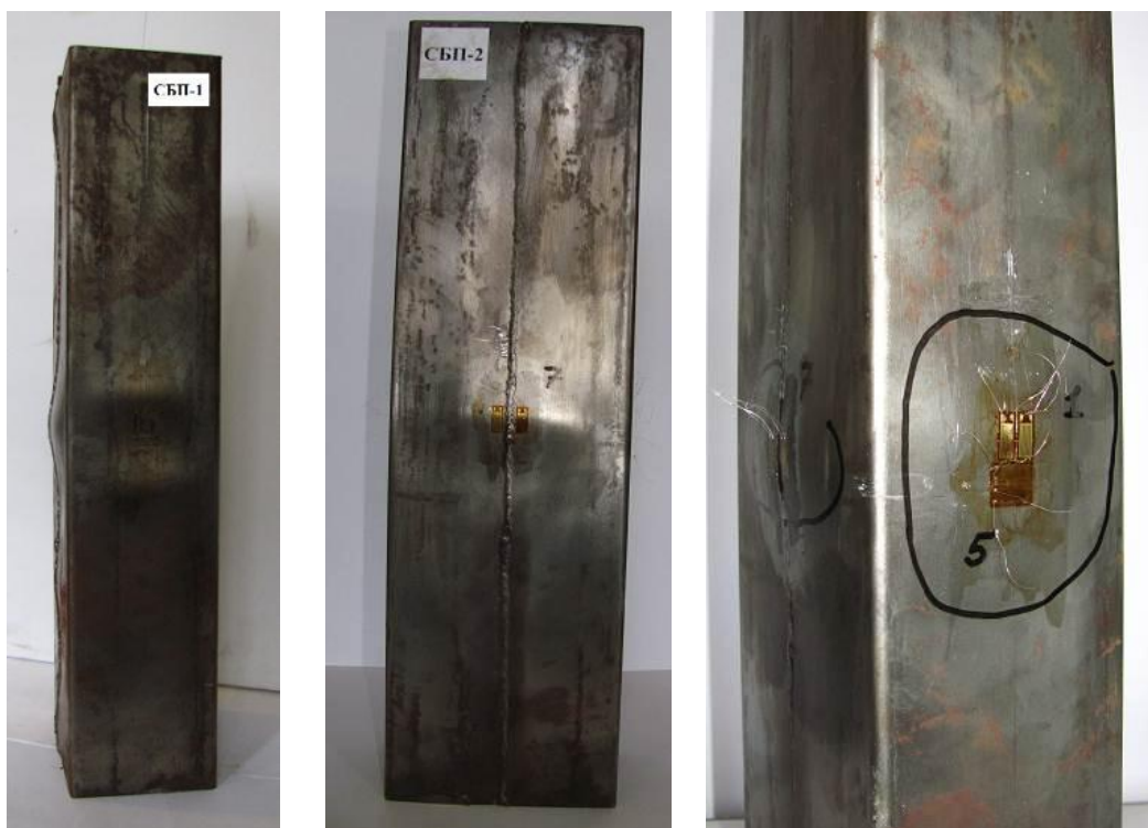
Рис. 4.7. Характер руйнування сталобетонних колон серії СБП після проведення випробувань на позacentровий стиск з випадковим ексцентриситетом
