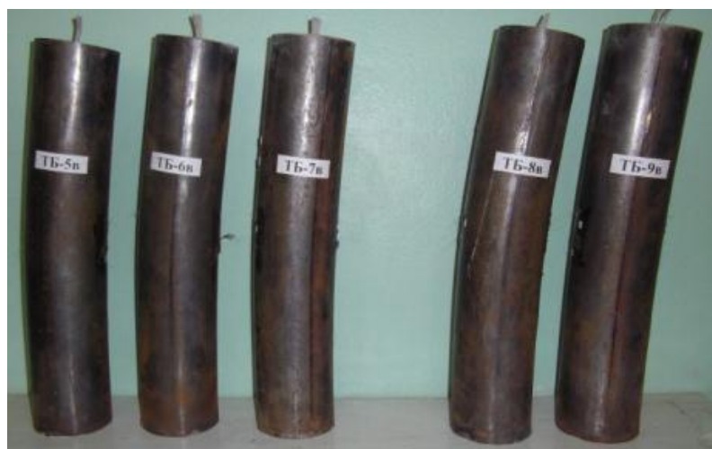
Рис. 4.9. Зовнішній вигляд позacentрово-стиснутих зразків серії ТБ
