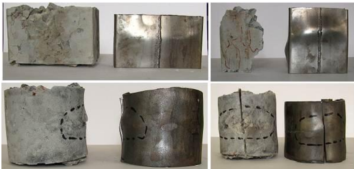
Рис. 4.8. Зовнішній вигляд бетонного ядра і сталеві оболонки після демон- тажу колон
