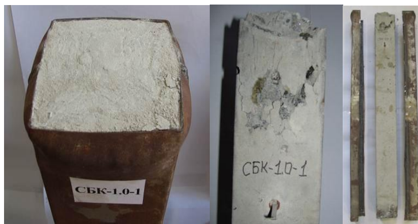
Рис. 4.19. Руйнування бетонного ядра в приопорній зоні
