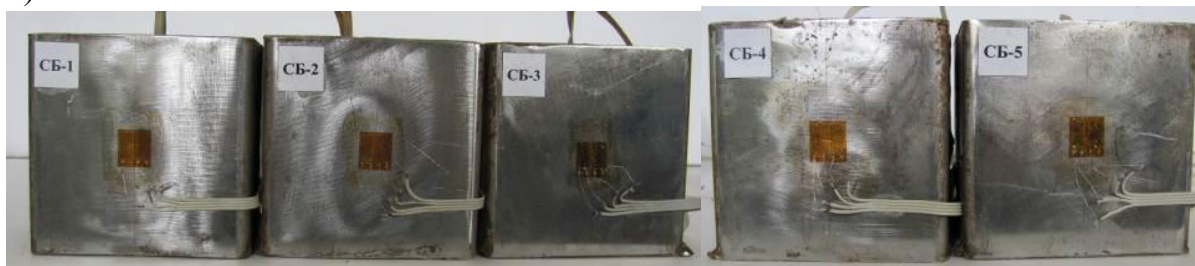
Рис. 3.8. Зовнішній вигляд зразків перед проведенням випробувань: бетонні кубики 1 серії (а), бетонні кубики 2 серії (б), сталобетонні кубики 3 серії (в)
