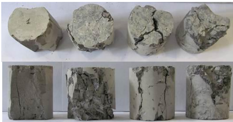
Рис. 3.7. Бетонні циліндри після випробування
