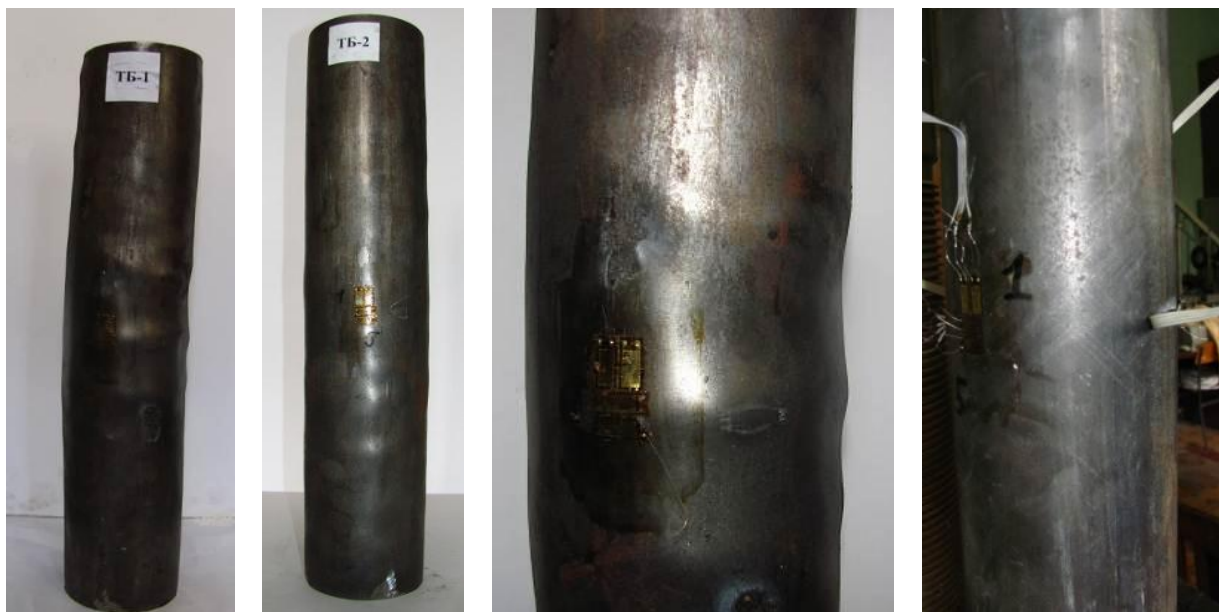
Рис. 4.5. Характер руйнування сталебетонних колон серії ТБ після проведення випробувань на позацентровий стиск з випадковим ексцентриситетом
