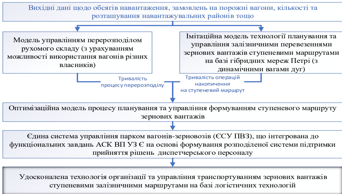
Рисунок 2.7 - Схема вирішення завдання удосконалення процесів організації та управління транспортуванням зернових вантажів ступеневими залізничними маршрутами
