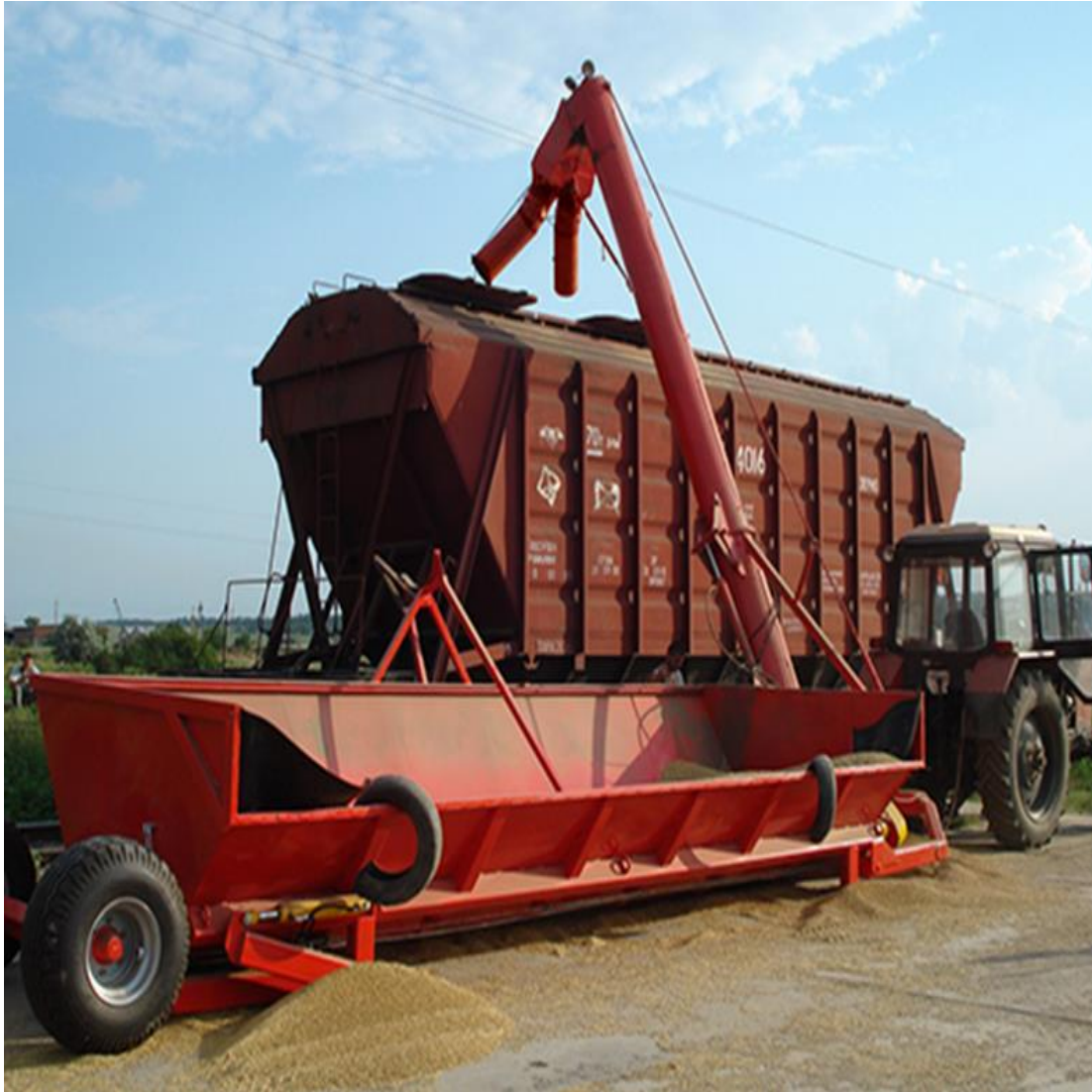
Рисунок Б.1 - Мобільний наземний перевантажувальний комплекс для зернових вантажів
