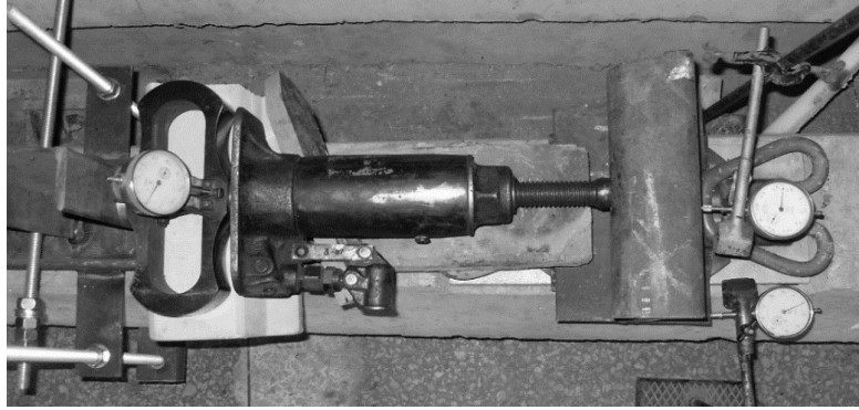
Рис. 2.15. Схема випробувань вузлів скріплень ТРЕП та ТРЕП–Ш для визначення жорсткості упорів при горизонтальних поперечних навантаженнях
