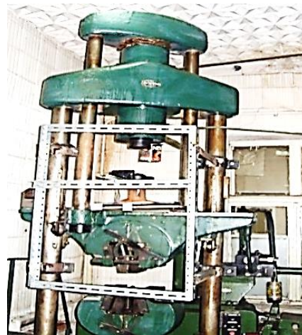
Рис. 2.12. Випробування прокладок ППТ і ПНТ при динамічному навантаженні
