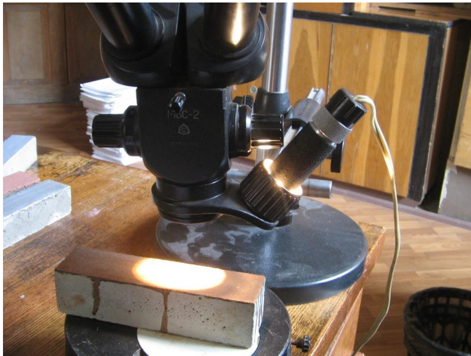
Рис. 4.12 Мікроскопічні дослідження композитів з електропровідними наповнювачами: a – міддю Cu ; б – алюмінієм Al ; в – цинком Zn ; г – графітом C ; д – бінокулярний мікроскоп МБС-2
