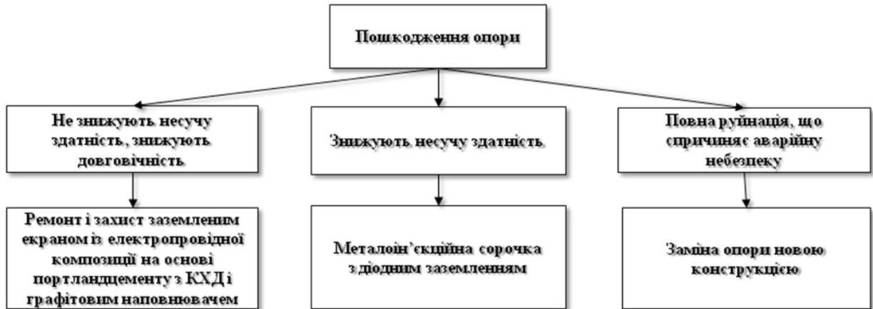
Рис. 5.2 Схема вибору способу ремонту і захисту опор високих пасажирських платформ від характеру пошкоджень
