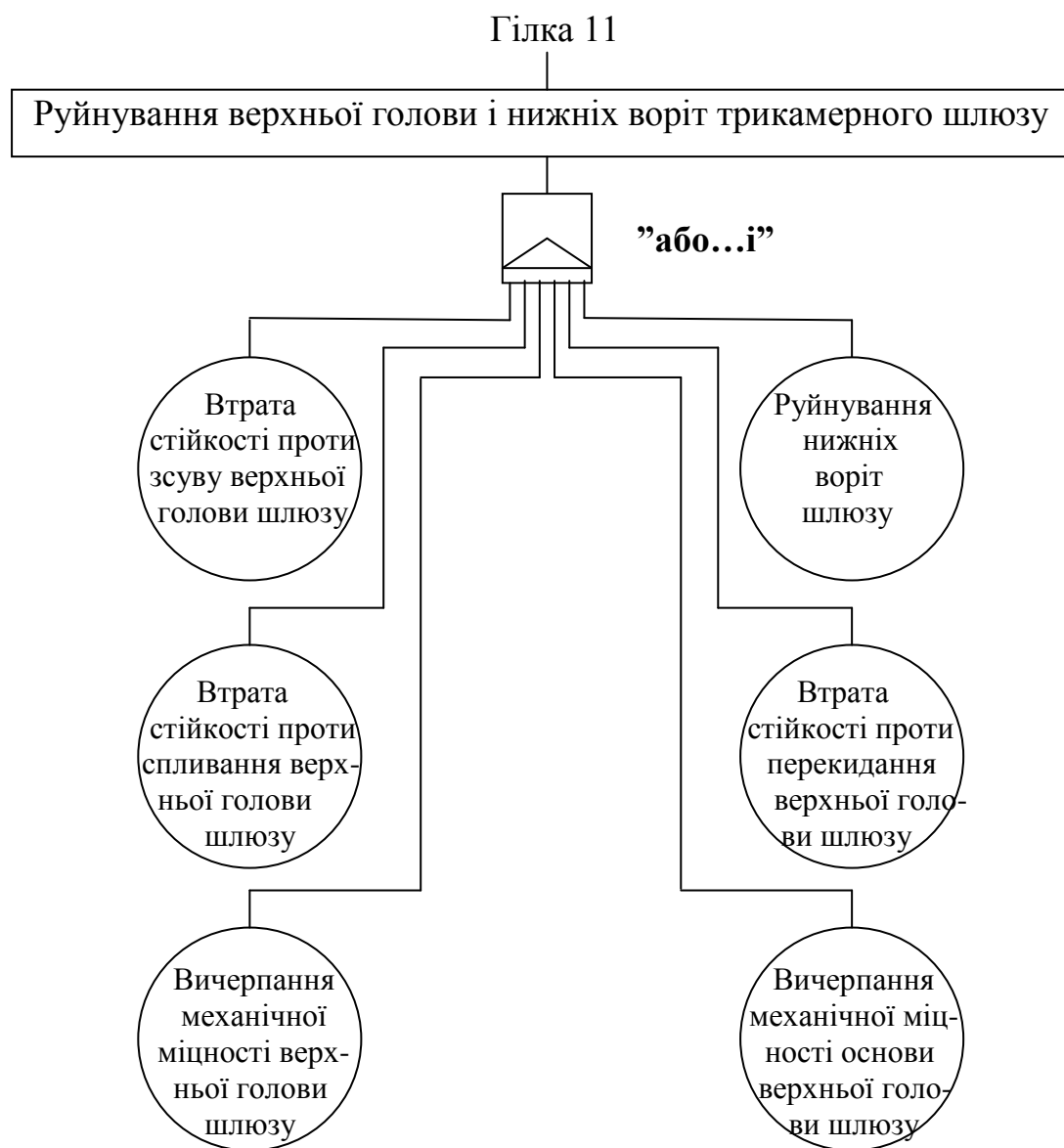
Рис. Т.66. Гілка 11-го розрахункового дерева відмов і несправностей, які приводять до виникнення надзвичайної ситуації на Дніпровському гідровузлі
