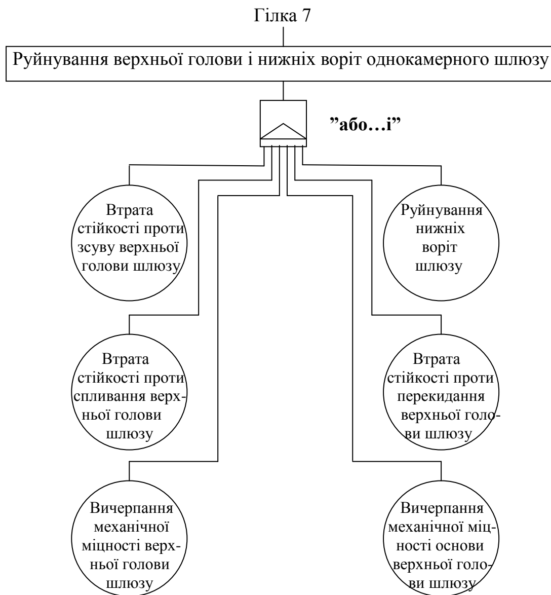
Рис. Т.62. Гілка 7-го розрахункового дерева відмов і несправностей, які приводять до виникнення надзвичайної ситуації на Дніпровському гідровузлі
