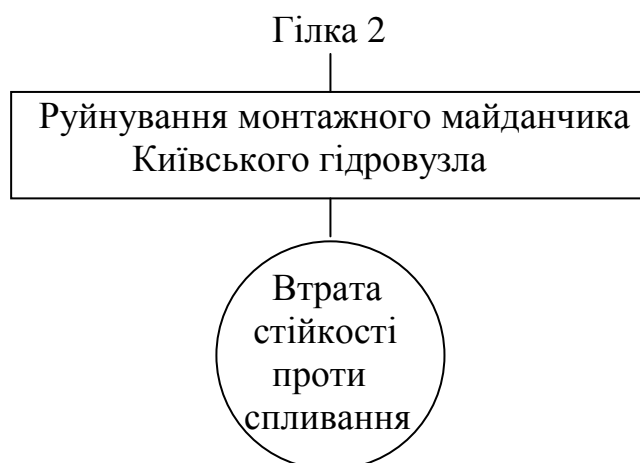
Рис. Ш.3. Гілка 2-го узагальненого дерева відмов і несправностей, які приводять до виникнення надзвичайної ситуації на Дніпровському каскаді гідроелектростанцій
