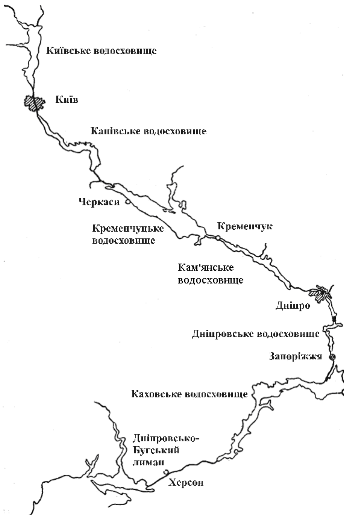
Рис. 6.1. Схема Дніпровського каскаду гідроелектростанцій
