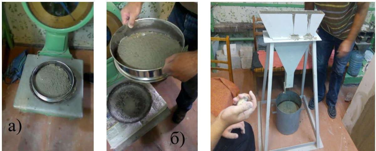
Рис. Ж.3. Проведення випробування свіжоприготовленої бетонної суміші на стійкість до розшарування та визначення в'язкості за допомогою V-подібної воронки: а) визначення фактичної маси бетонної суміші на ситі; б) визначення маси бетонної суміші, що пройшла через сито; в) V-подібна воронка
