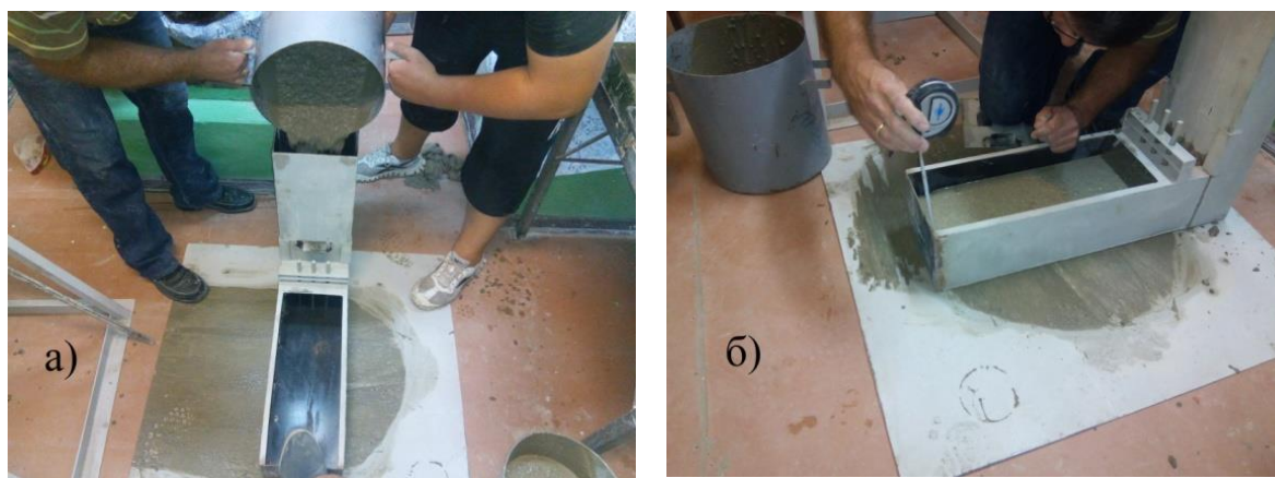
Рис. Ж.2. Проведення випробувань для оцінки здатності самоущільнюваної бетонної суміші долати перешкоди при протіканні через важкодоступні вузькі місця: а) завантаження бетонної суміші; б) визначення середньої глибини бетонної суміші
