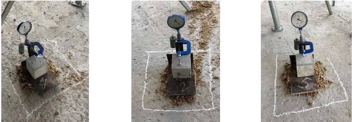
Рис. 4.15. Нумерація прогиномірів 6ПАО, встановлених на перекритті 2 поверху
