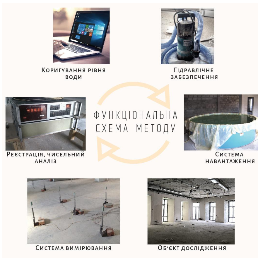
Рис. 4.7. Функціональна схема методу натурних випробувань
