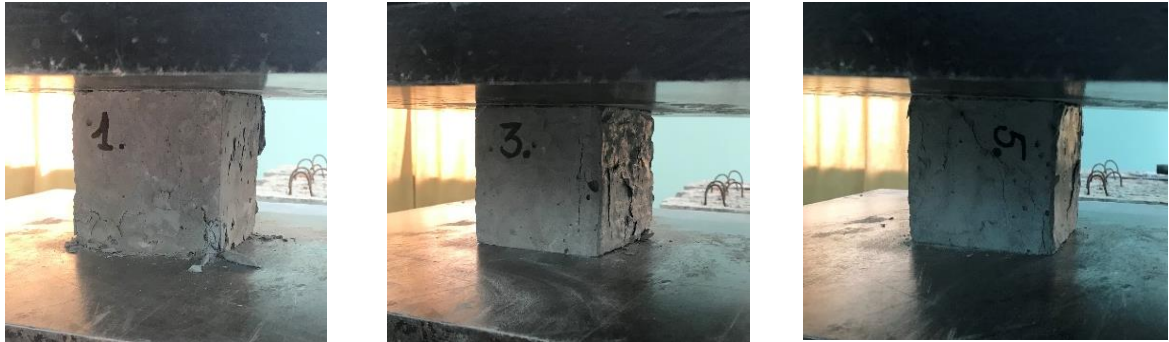
Рис. 4.2. Стандартні випробування по визначенню кубикової міцності бетону на стиск в пресі ПСУ-250
