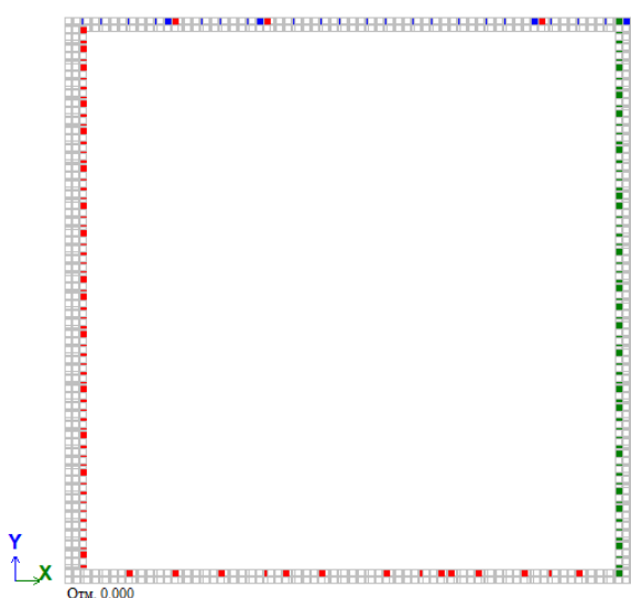
Рис. 2.26. Обпирання скінченно-елементної моделі розглянутої плити
