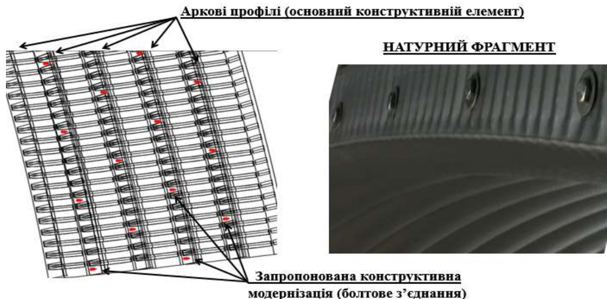
Рис. 3.14. Запропонована конструктивна реалізація облаштування болтового з'єднання.
