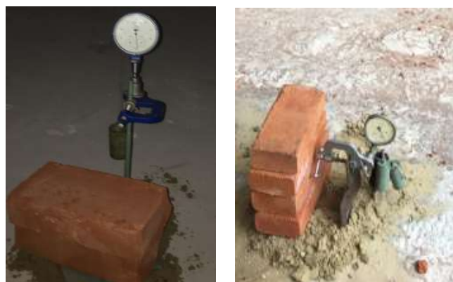
Рис. 4.7. Прогиноміри «БПАО», з ціною поділки 0,001 мм.
