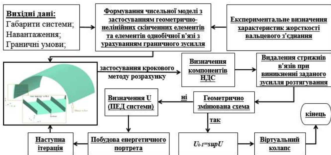
Рис. 3.2. Блок-схема алгоритму обчислення НДС системи з можливістю відображення настання прогресуючого обвалення
