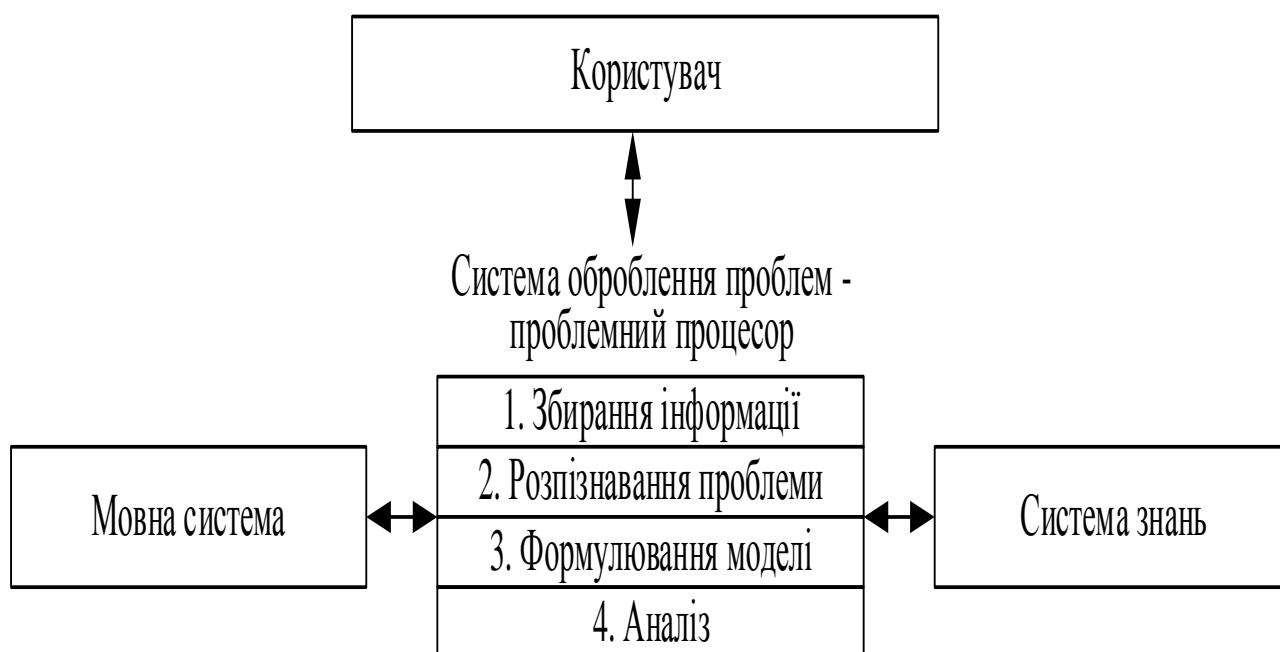
Рис. 3.3. Модель системи підтримки прийняття рішень, яка заснована на знаннях [324]
