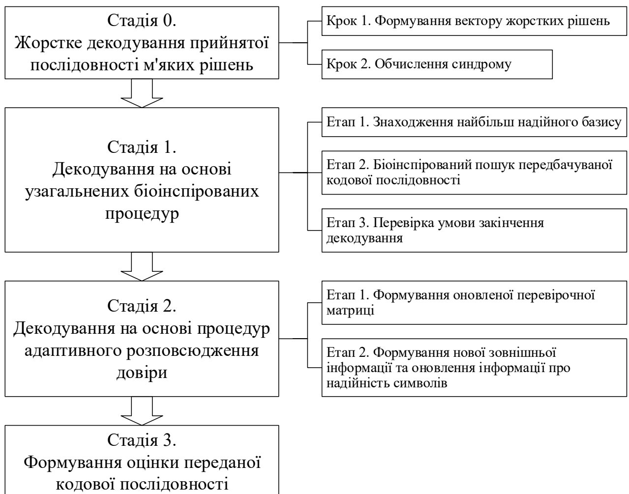
Рис. 4.6 – Схема адаптивного методу м'якого декодування алгебраїчних згорткових кодів перемержування
