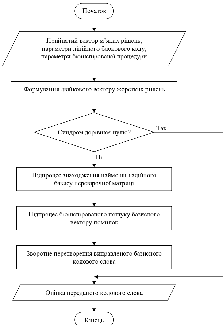
Рис. 2.7. Схема алгоритму біоінспірованого м'якого декодування високошвидкісних лінійних блокових кодів
