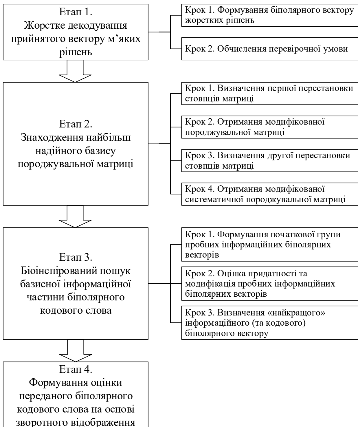
Рис.2.1. Схема біоінспірованого методу м'якого декодування лінійних блокових кодів на основі породжувальної матриці
