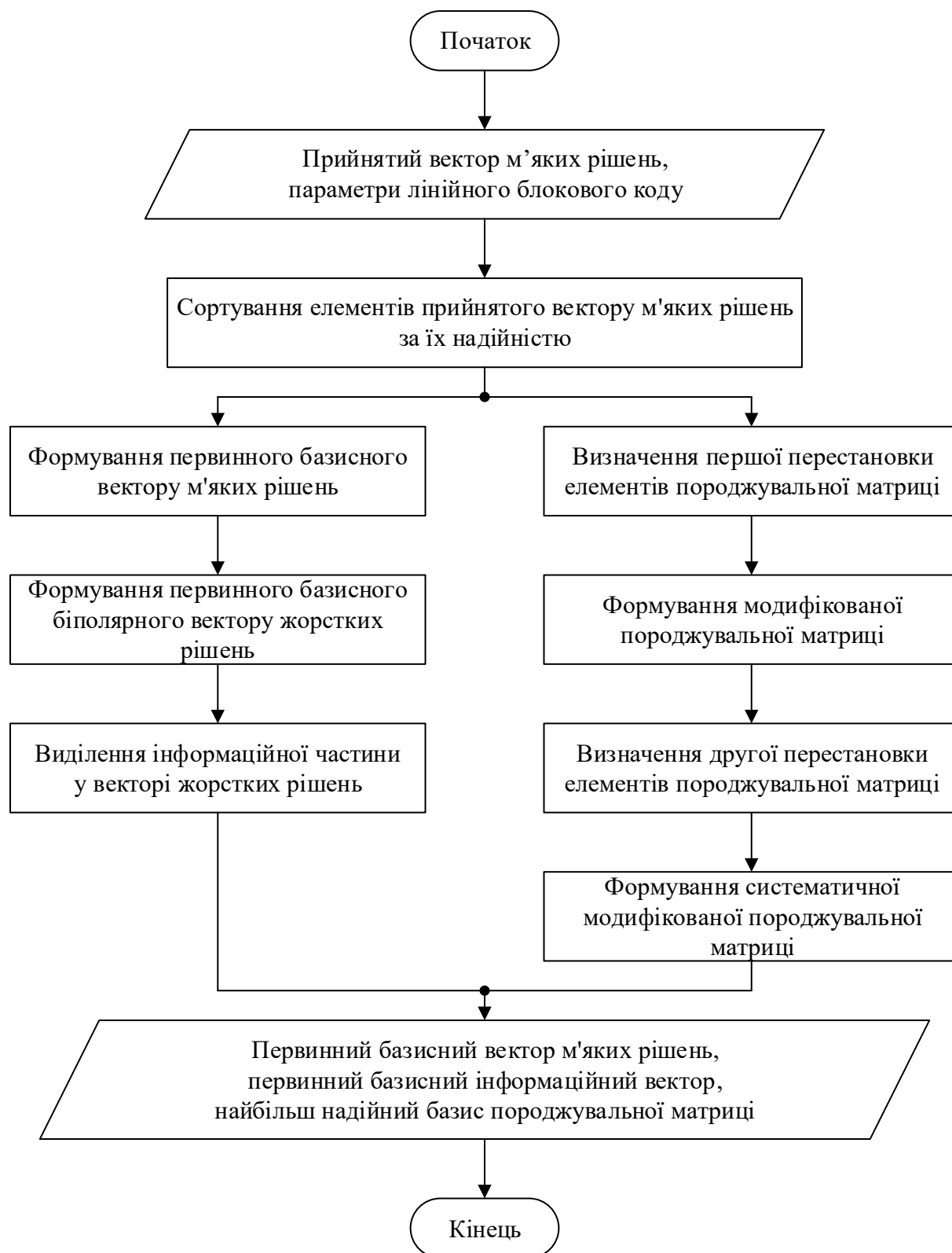
Рис. 2.3. Схема алгоритму підпроцесу знаходження найбільш надійного базису породжувальної матриці
