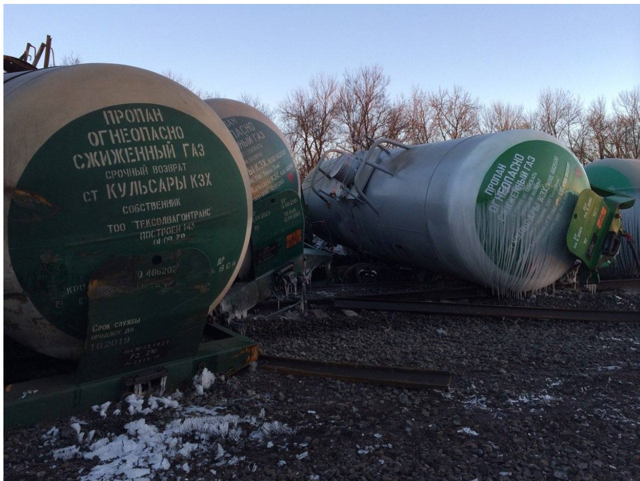
Рисунок 1.10 – Наслідки аварійної ситуації з небезпечним вантажем класу 2
