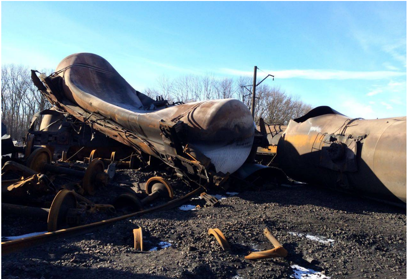
Рисунок 1.11– Наслідки аварійної ситуації з небезпечним вантажем класу 2
